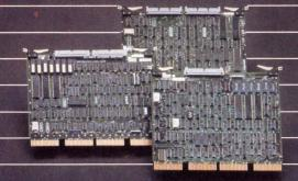
1/2" TAPE—CONTROLLER/COUPLER PERTEC I/0 • TM-II, TSV05/TS-II/TU80 emulations
