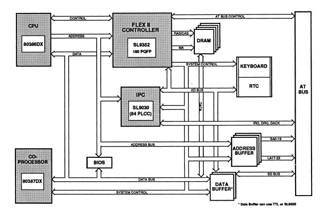
Flex II / 386DX<sup>TM</sup> Block Diagram
