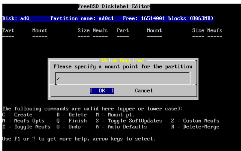
Σχήμα 3.23. Επιλέξτε το Σημείο Προσάρτησης του Root
