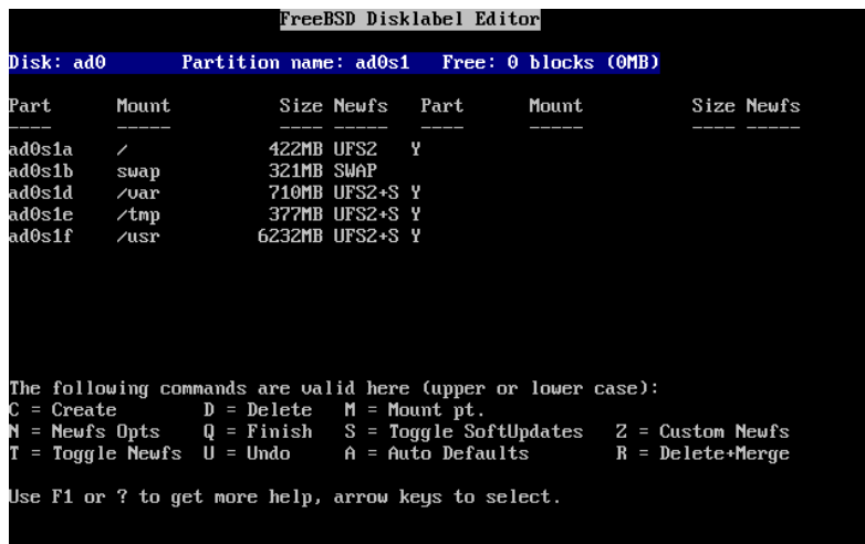
圖形2-19. Sysinstall 的Disklabel 編輯器—使用自動分配
