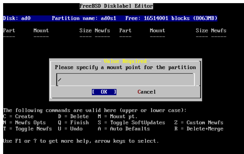
Figuur 2-23. Root mountpunt kiezen
