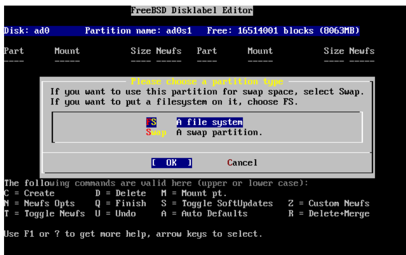
Rysunek 2.20. Wybór typu głównej partycji
