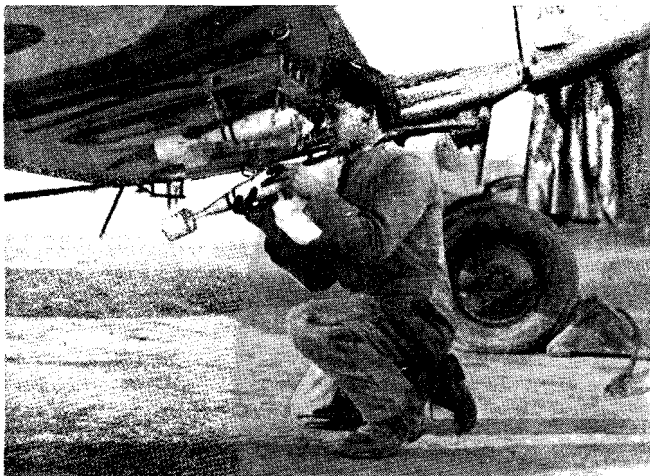
POSTAVLJANJE SVIJETLEĆIH BOMBA NA ZRAKOPLOV
