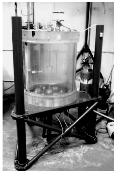
Рис.12 Рабочая камера из поликарбоната. Диаметр 80см, высота 80см [14].
