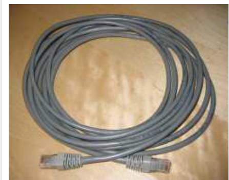
Ethernet Twisted-Pair-Kabel mit RJ45-Steckern
