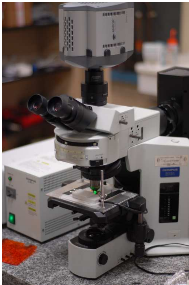
FIG. 3.15 – Vue du montage complet de caractérisation par microscopie à fluorescence, incluant : (à gauche) le générateur de la lampe à vapeur de mercure, (en haut) la caméra haute sensibilité, (au centre) le microscope à fluorescence, sur la platine duquel est fixé le montage Peltier.
