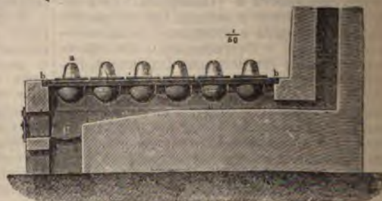
Фиг. 2. Газерная печь (продольный разрезъ).
