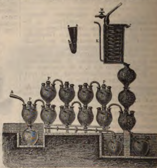
Фиг. 6. Конденсаціонный аппаратъ по системѣ Деверса и Пассона.
