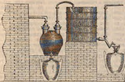
Фиг. 7. Стущеніе съ помощью холодильника.
