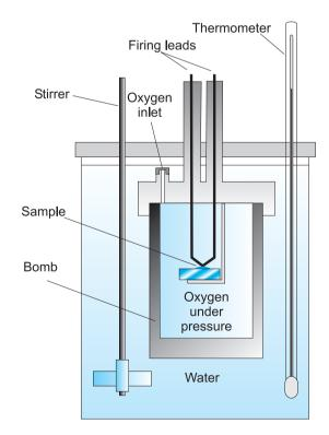
Fig. 6.7 Bomb calorimeter
