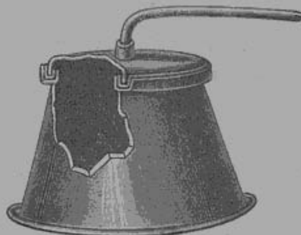
Рис. 41. Железная реторта, крышка которой вставляется въ желобъ и замазывается гипсомъ.
