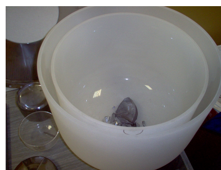
Crisol empleado en el método de Czochralski.
