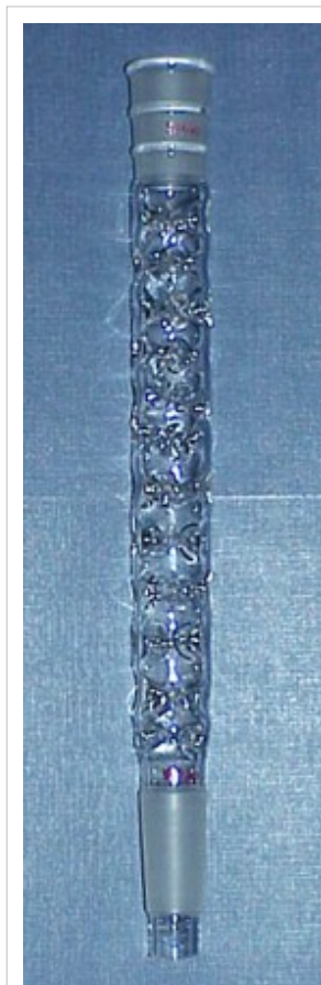
Columna Vigreux de vidrio de borosilicato con juntas de vidrio esmerilado 24/40. Los tamaños típicos son de 200 mm y 300 mm, que se refieren a la longitud de la separación efectiva o longitud de la hendidura.
