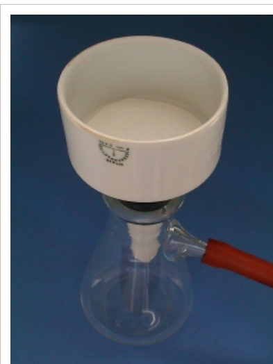
Un embudo Büchner conectado a un kitasato y a una bomba de vacío.
