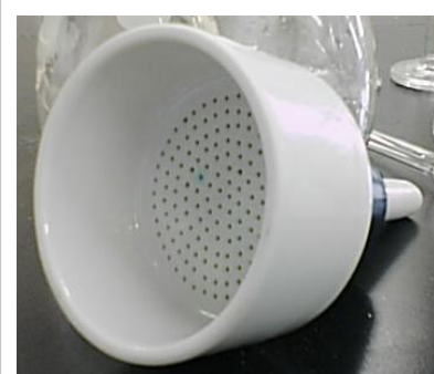
Embudo Büchner de porcelana. Se observan los orificios de la base.
