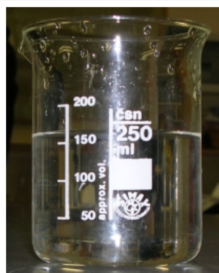
Imagen de un vaso de precipitados, tipo vaso Griffin, de perfil bajo.
