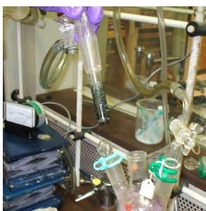
Cristales color verde oscuro de niqueloceno, recién sublimado en un dedo frío.
