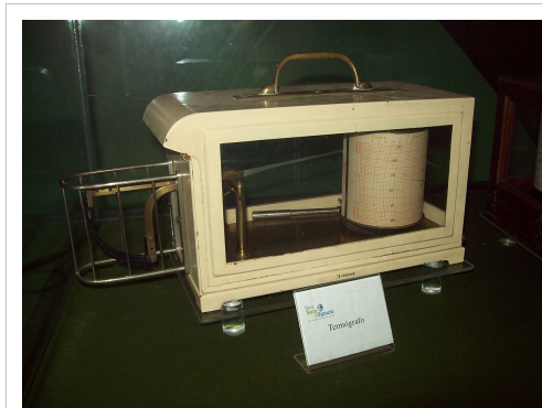
Un termógrafo, este aparato es capaz de medir y registrar las variaciones de temperatura.
