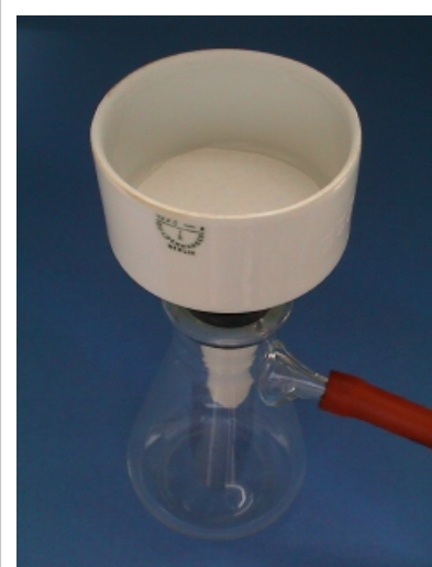
Un embudo Büchner conectado a un kitasato y a una bomba de vacío.
