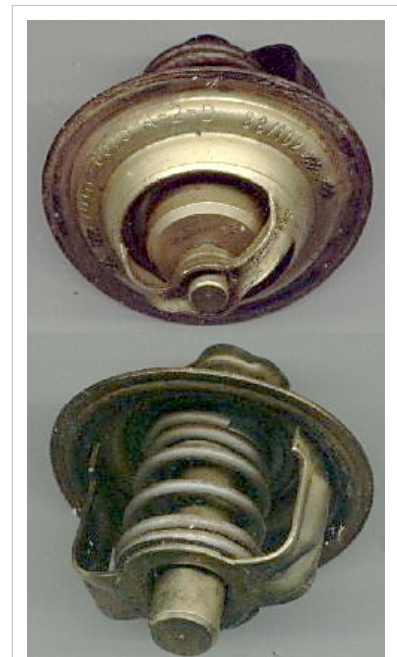
Termostato de parafina para radiadores de vehículos.
