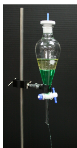
Embudo de decantación con grifo de cierre de plástico, mostrando la capa acuosa coloreada.
