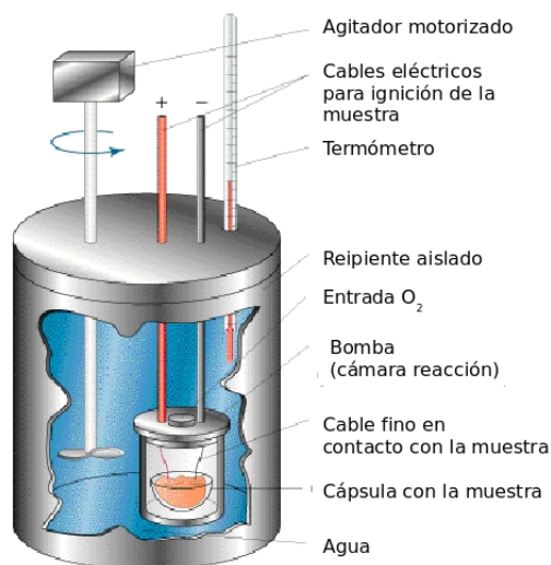
Figura 2.2: Calorímetro de tipo bomba: este calorímetro se utiliza para obtener el calor de reacción a volumen constante.
