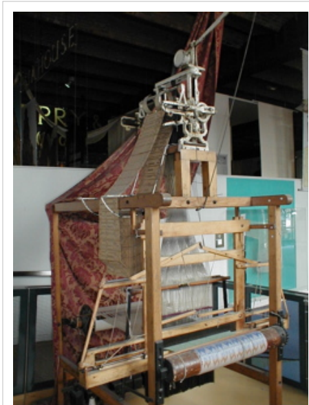
Telar Jacquard en el Museo de la ciencia y la industria, en Mánchester (Inglaterra).
