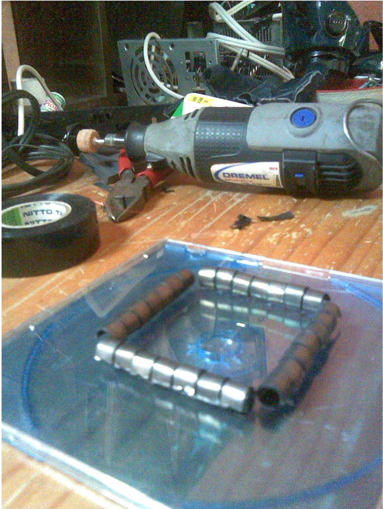
Aquí están las placas colocadas con su recubrimiento interior de cinta de aislar.
