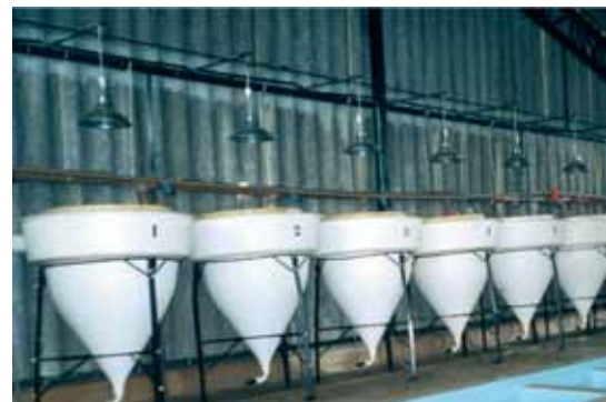
Figura 6. Incubadoras cónicas con flujo ascendente de agua.
