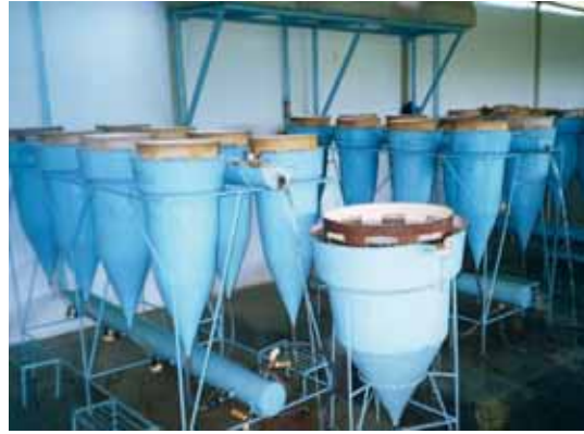
Figura 10. Incubadoras cónicas de flujo ascendente de agua.
