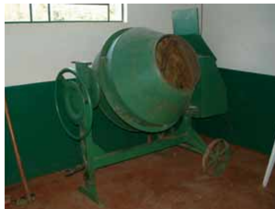
Figura 20. Mezcladora de alimento y cuarto de almacenamiento
