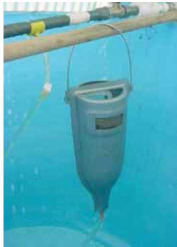
Figura 12. Prototipo de incubadora experimental de 2 L.
