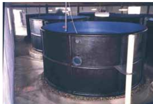
Figura 3. Tanques de fibra de vidrio de 10 toneladas, con control de temperatura y luminosidad, para el almacenamiento de los reproductores y obtención de los desoves.
