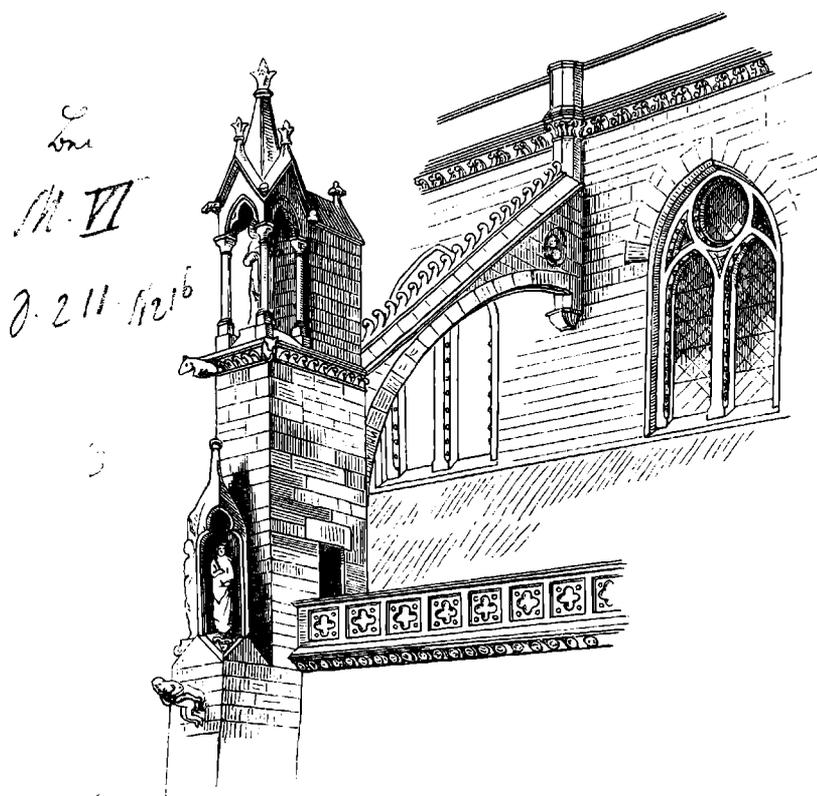
Fig. 73. Strebensystem der älteren Theile des Langhauses am Münster zu Freiberg
