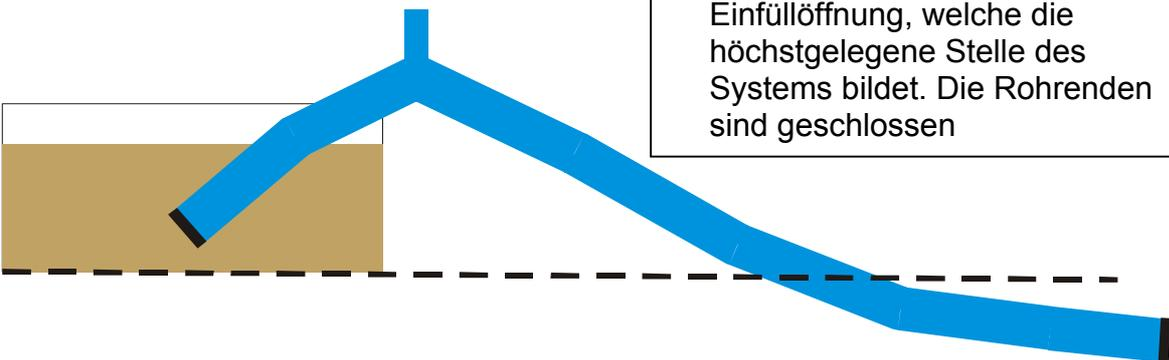
2. Einfüllöffnung schließen, Rohrenden öffnen.
