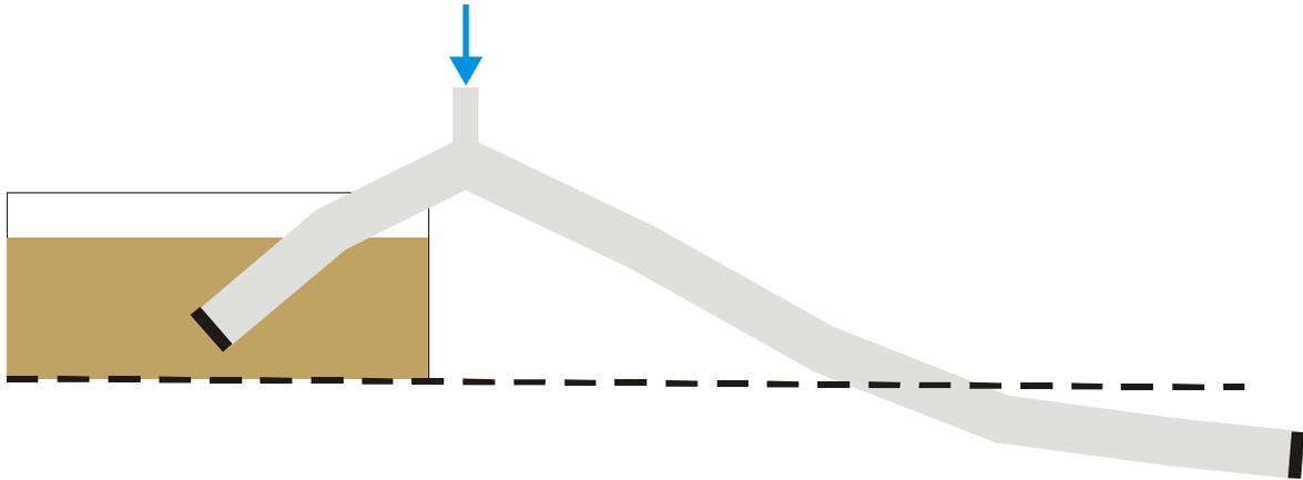
1. Befüllen des Rohrs z.B. mit Leitungswasser. Am besten über eine verschließbare Einfüllöffnung, welche die höchstgelegene Stelle des Systems bildet. Die Rohrenden sind geschlossen
