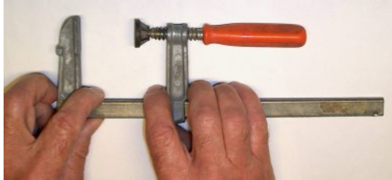
Figuur 9.11: Lijklem: arm verschuiven
