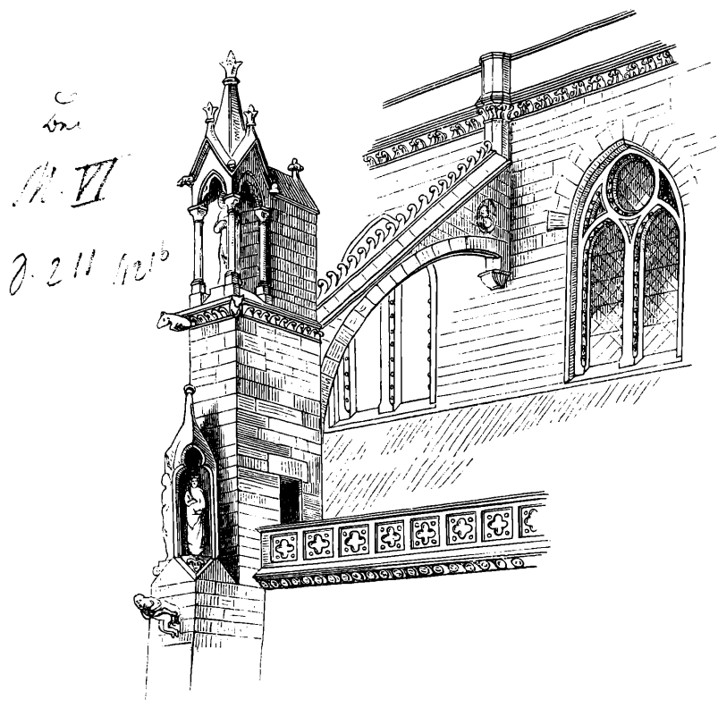
Fig. 73. Strebesystem der älteren Theile des Langhauses am Münster zu Freiberg burg
