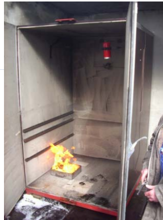
Abb. 1: Schema der Messeinrichtung zur Überprüfung von Löschaerosolgeneratoren.
