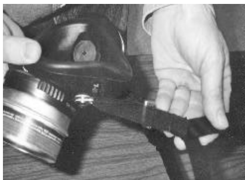
Проверка ремней оголовья и застёжек. Фотография сделана NIOSH
