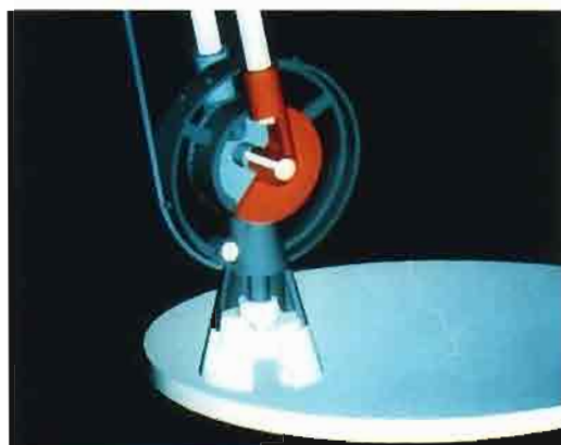
Spaccato degli elementi componenti il primo e il secondo snodo
