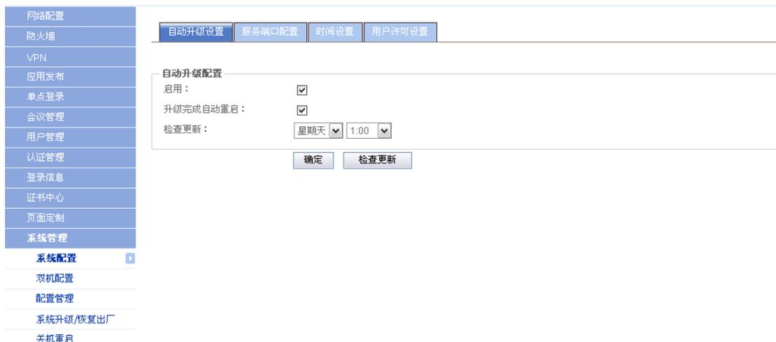
可以自动检测到最新版本，进行自动升级。默认是启用的状态，升级完后自动重启。可以根据需要自行配置。可以手动设置更新时间。可以手动检查是否有最新版本进行更新处理。
