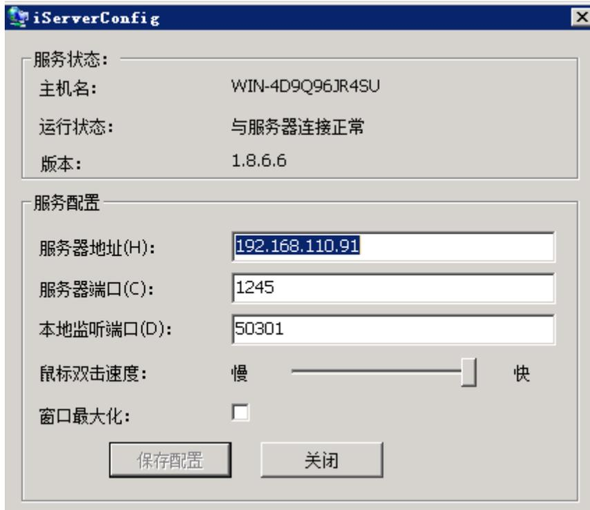
**服务器状态:** 主机名显示的是主机名称；运行状态显示的是与 SGA 连接状态，显示正常则与 SGA 连接成功，显示失败则没有与 SGA 连接成功；版本显示的是当前软件的版本号
