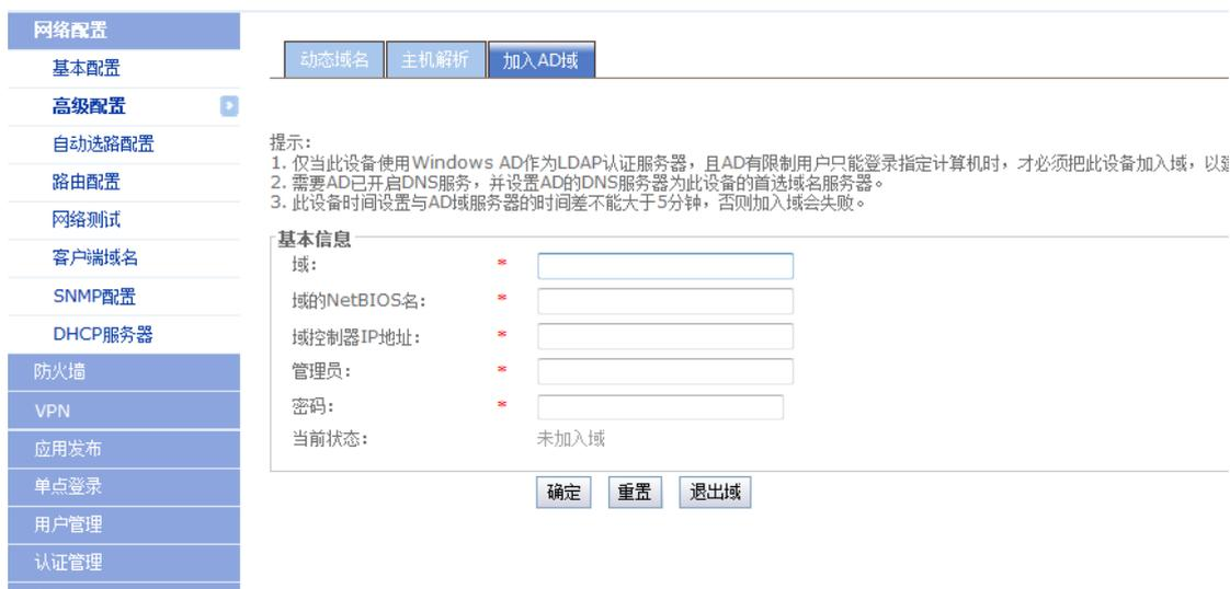
**提示:** 1. 仅当此设备使用 Windows AD 作为 LDAP 认证服务器, 且 AD 有限制用户只能登录指定计算机时, 才必须把此设备加入域, 以建立信任关系。若 AD 域用户可登录到所有计算机, 则无需把此设备加入域, 亦可进行认证。 2. 需要 AD 已开启 DNS 服务, 并设置 AD 的 DNS 服务器为此设备的首选域名服务器。3. 此设备时间设置与 AD 域服务器的时间差不能大于 5 分钟, 否则加入域会失败。
