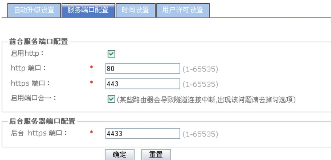
可设置前台 http 重定向，修改前台和后台 https 端口，设置端口合一。
