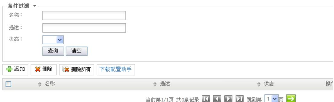
点击上图中的添加，出来以下界面，在资源名称处填写助手单点登录资源前台显示名称，在上传配置文件处通过浏览按钮，选择用助手工具制作出来的 XML 文件路径，配置以上这些即可。其他配置项需要根据 web 系统的具体情况来配置。
