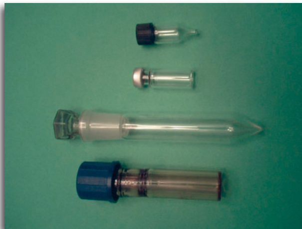
Bild 1: Verwendete Glasgefäße (von oben nach unten: Certainflasche, Spitzglas mit 14,5 Normschliff, Probenglas mit Aluminiumbördelkappe und Septum, Mikroflasche mit Schraubverschluss und Septum).
