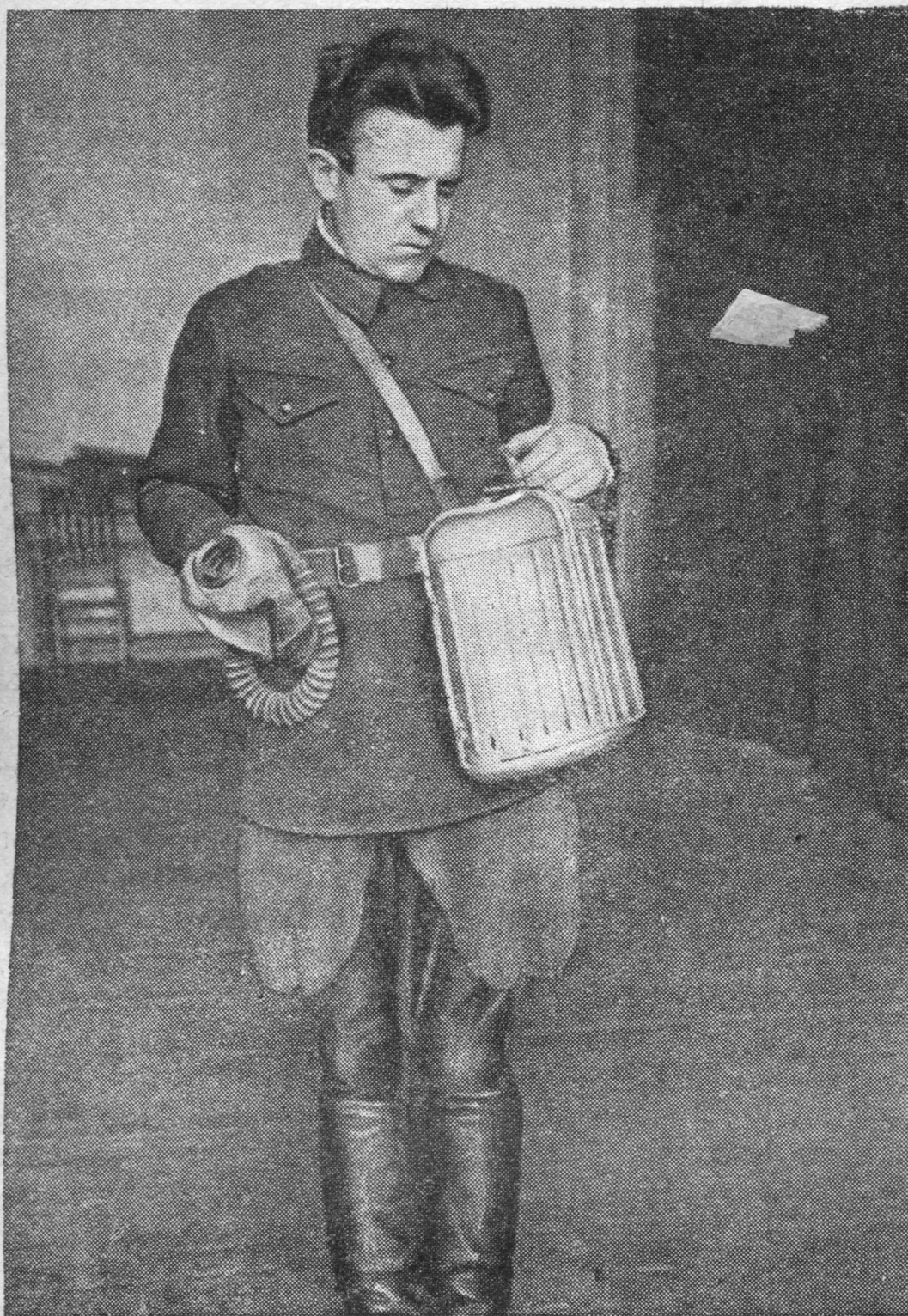
Рис. 5. Отвинчивание заглушки на верхней соединительной коробке (см. стр. 18)
