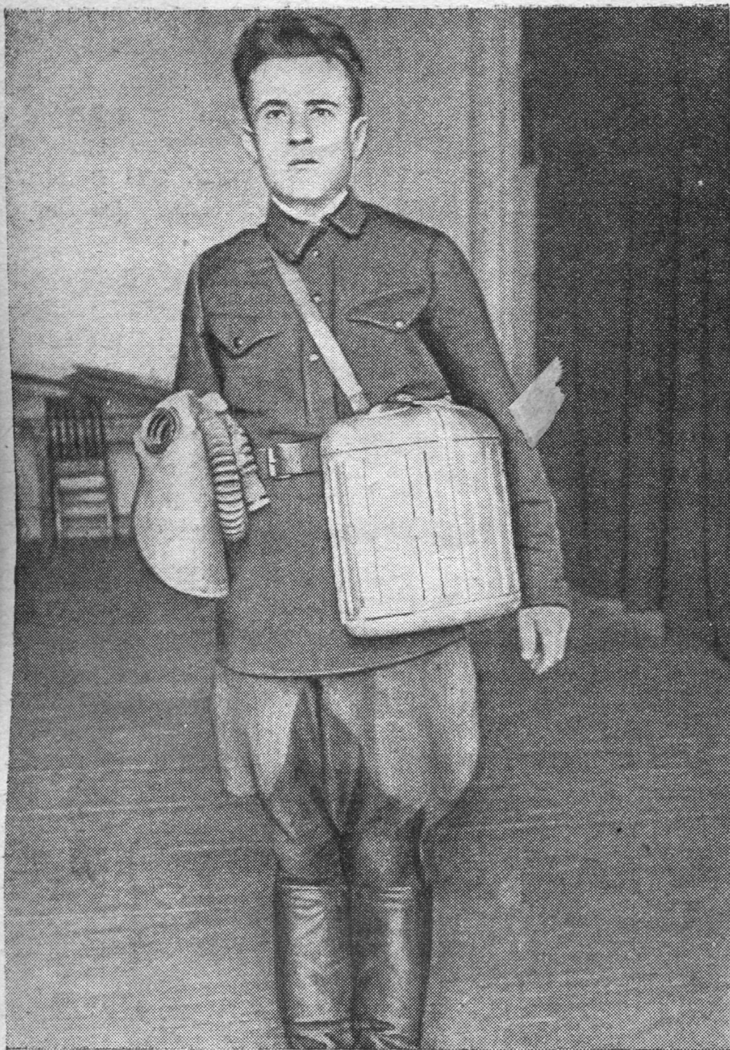
Рис. 4. Для пользования противогазом маска с гофрированной трубкой вынимается из отделения с дыхательным мешком (см. стр. 18).
