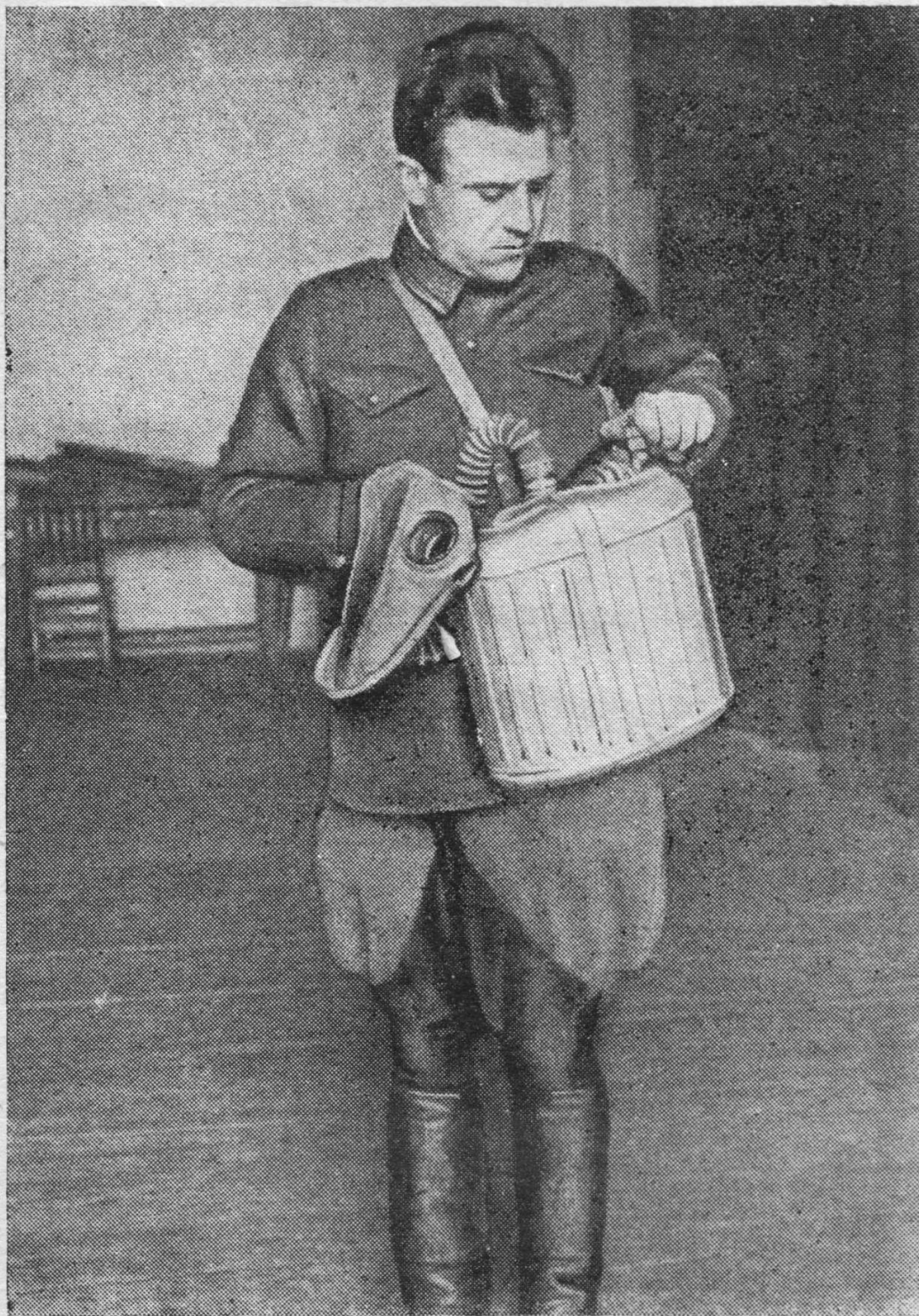
Рис. 7. Открытие вентиля кислородного баллона (см. стр. 18)
