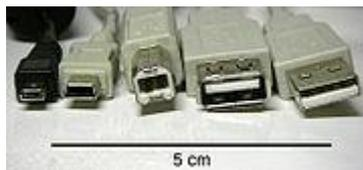
Tipos diferentes de conectores USB (de izquierda a derecha): Micro USB, mini USB, tipo B, hembra tipo A, tipo A.
