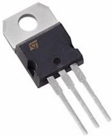
U oznaci stabilizatora, XX označava vrijednost izlaznog napona. Tako, npr. stabilizator 7805 ima izlazni napon 5V. Minimalna i maksimalna vrijednost ulaznog napona, za svaki tip, su definisane. Tako, npr.: za kolo 7805 – Vulmin = 7V, a Vulmax = 25V, za kolo 7808 – Vulmin = 10,5V, a Vulmax = 25V, za kolo 7805 – Vulmin = 17,5V, a Vulmax = 30V, itd. I ovdje se često vezu opcioni kondenzatori.
