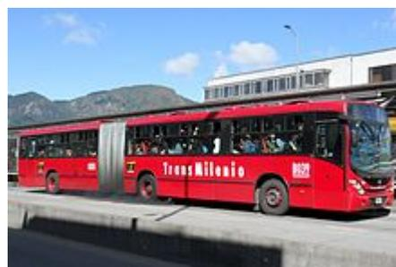
En la parte frontal exterior y hacia el lado de las puertas del articulado hay tableros electrónicos que indican el número de ruta y el destino del vehículo.
