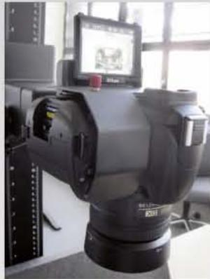
SD Card Einschub, Schalter zur Aktivierung des Kontrollmonitors
