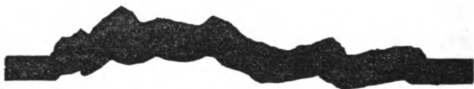
Fig. 25. — Coupe horizontale d'un écrasement de la couche dite la Grande-Mine, à Auriol.
