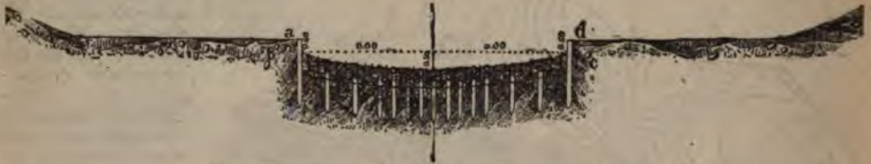
Фиг. 5 Разрѣзъ запруды изъ заплетеннаго хвороста.
