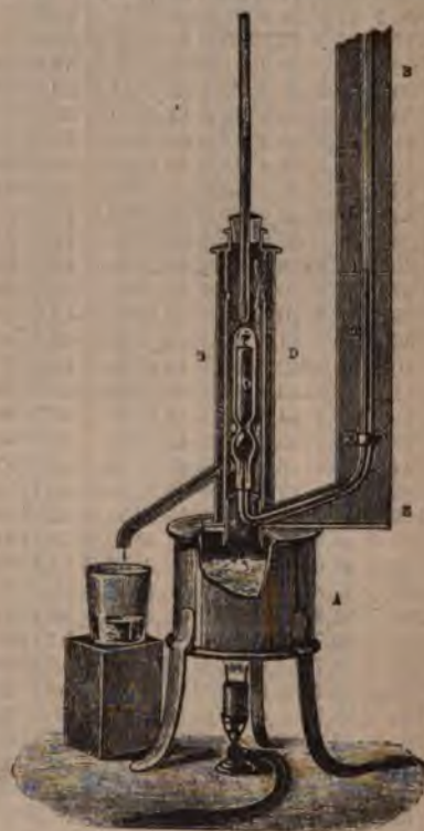
Фиг. 4. Вазориметръ: A —кварцильникъ, B —ртутный манометръ, C —сосудъ, гдѣ помѣщается спиртовая жидкость, D —крышка кварцильника, съ двойными стѣнками.
