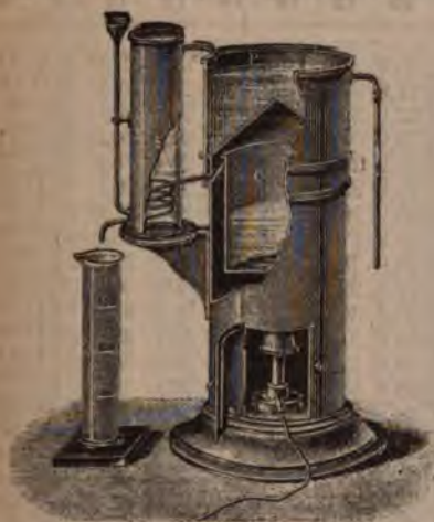
Фиг. 2. Приборъ для отгонки спирта изъ спиртовыхъ жидкостей.
