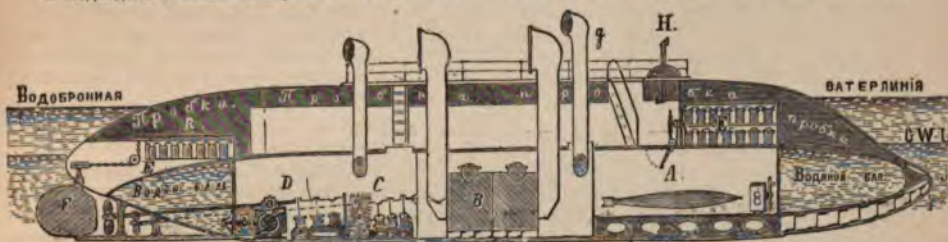
2. Подводный водобронный миноносецъ С. К. Девецкаго, 1892 г.
