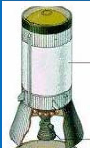
Impulsada por un motor J-2, funciona tres minutos y sitúa la nave en órbita de aparcamiento. Después se pone en marcha cinco minutos para alcanzar la velocidad de inyección en órbita lunar.
