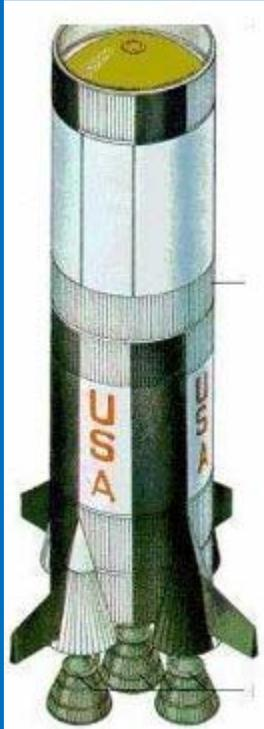
Sus cinco F-1 alimentados por queroseno y oxígeno líquido funcionan 2,30 minutos y sitúan a la nave a 60 km de altura y 9.850 km/h.
