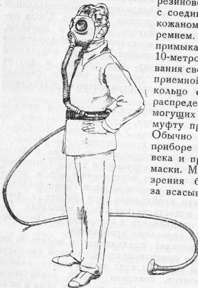
Рис. 63. Прибор Дегеа с самовсасыванием свежего воздуха.
