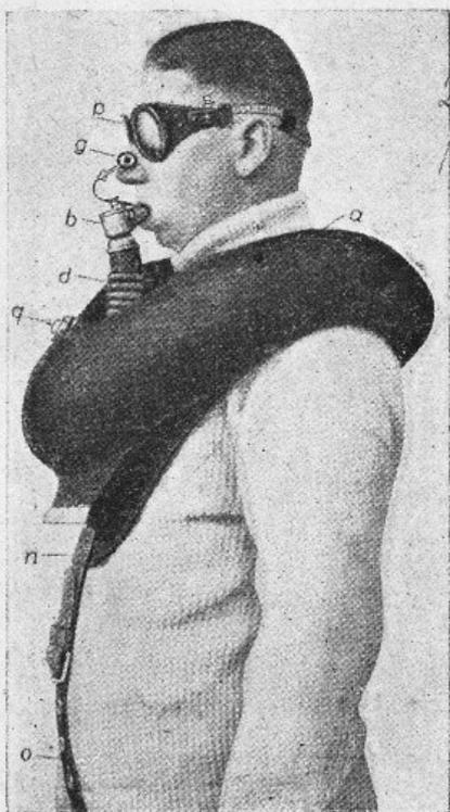
Рис. 109. Прибор Дрегера легкого типа (на 15 м.) мод. 1929 г, а—дых. мешок, б—мундштук, в—носовой зажим, г—очки, д—дых. рукавчик, е—клапан избытка воздуха, ф—ремни для удержания прибора
