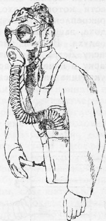
Рис. 45. Газовая маска Дегеа СО (специальный тип).
