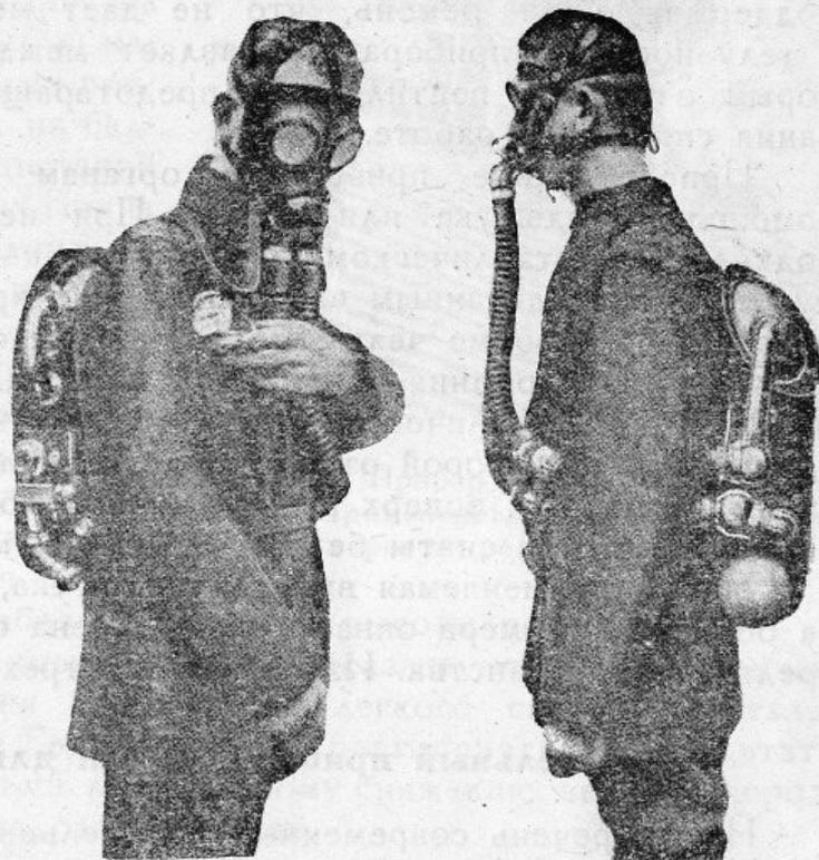
Рис. 99. Прибор „Аудос“ на 2 часа, мод. 1927 г.
