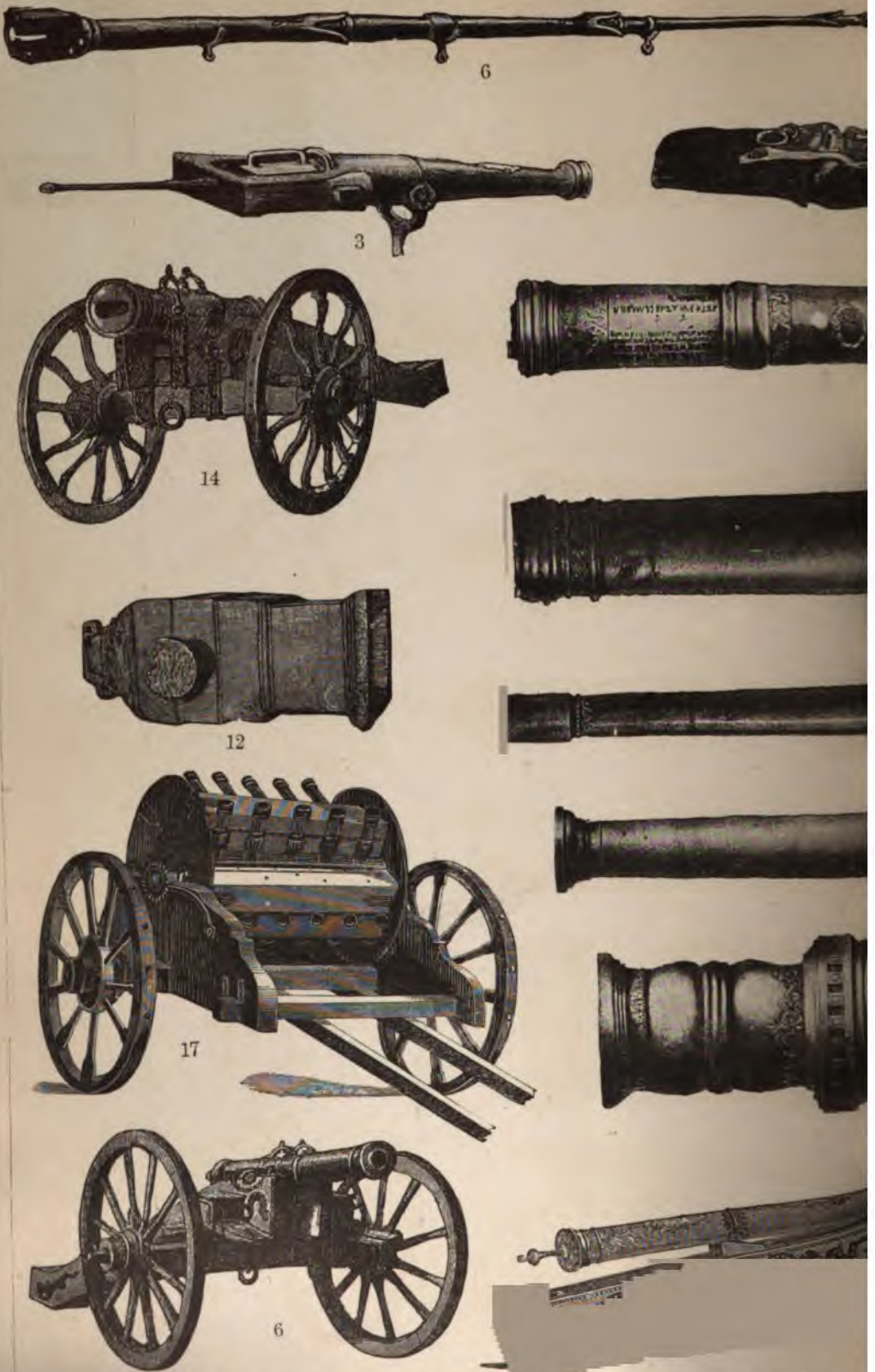
Русския орудія до начала XIX в. 1—2. Железные пищали XIV в. 3. Железная пищаль XV в. 4. 2-фунт 6-фунтовая пищаль „Гаманъ“ 1690 г. 5. 40-фунтовая пушка „Орель“ 1692 г. 10. Пищаль Троицко-Сергиев 14. Шуваловская секретная гаубица (единорог XVIII в.). 15. Византия (XVIII в.)
