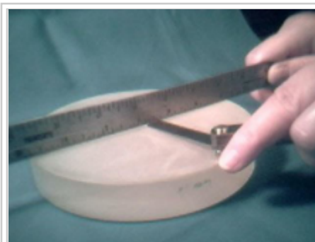
Đặt thước dọc theo đường kính gương và đo độ sâu bằng các lá căn chuẩn tại tâm gương
