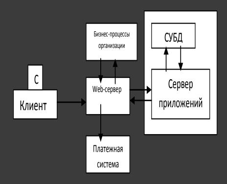
Web-сервер - распределяет поступающие запросы с возможным разграничением доступа.
