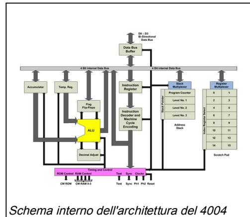
Schema interno dell'architettura del 4004
