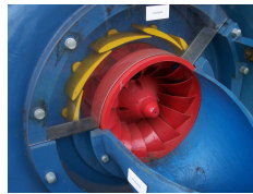
Abb. 16: Leitwerk einer Francis-Turbine für minimale Leistung eingestellt
