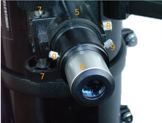
Abbildung 52: Okular an einem Newton Teleskop
