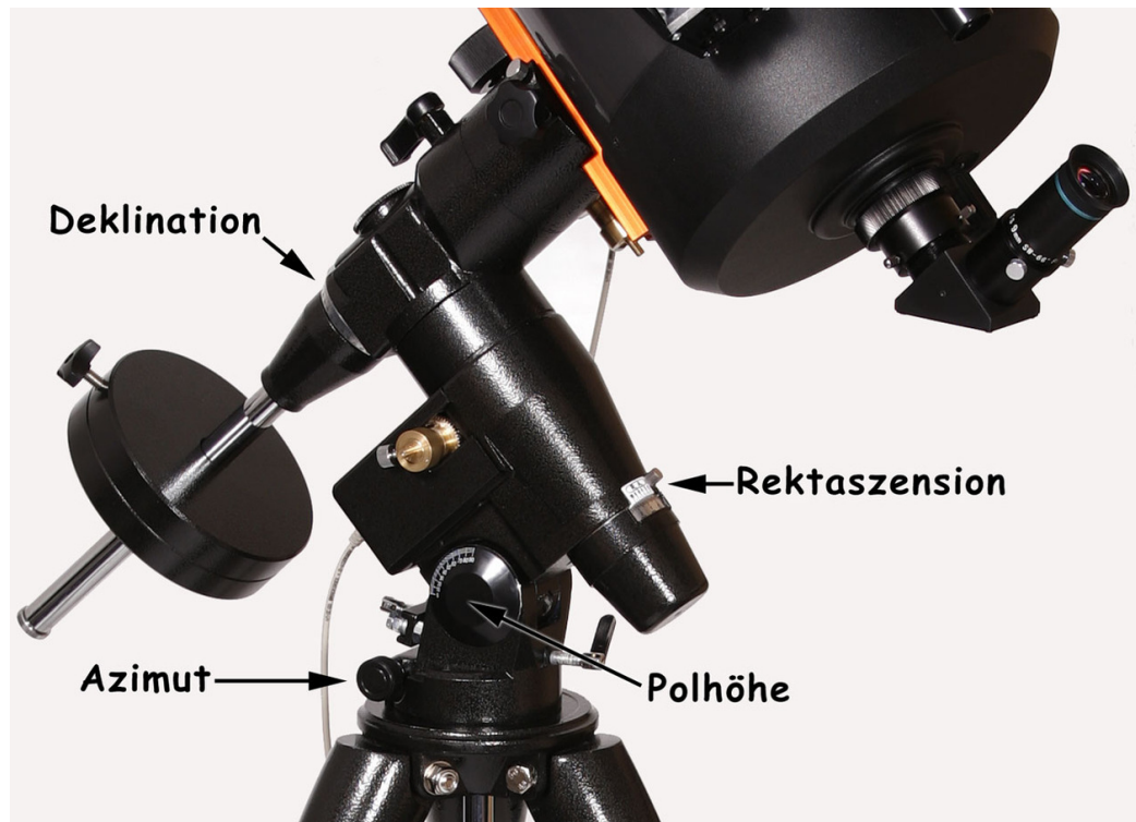
Abbildung 55: Deutsche Montierung und ihre Freiheitsgrade
