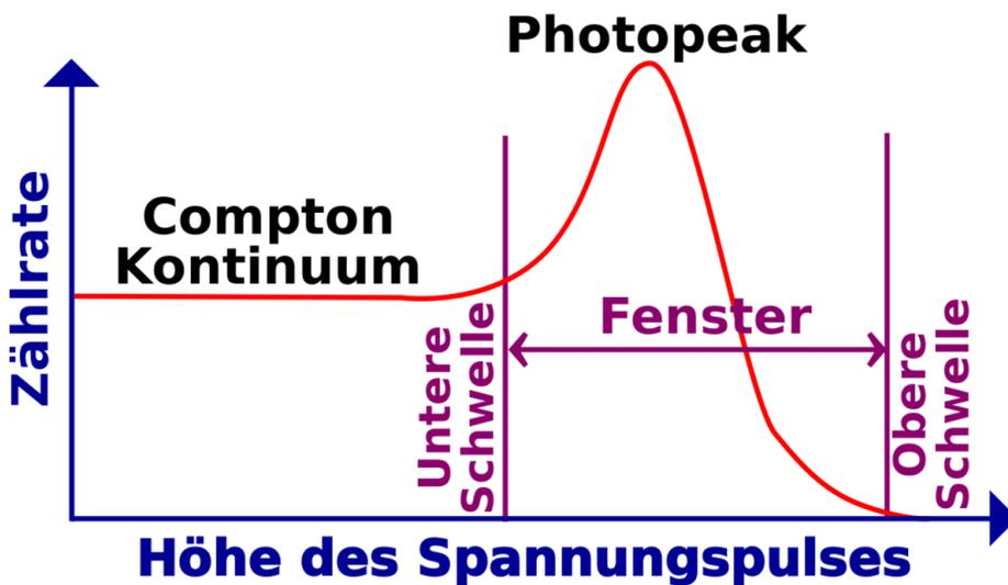
Abb. 49 Gammaspektrum mit eingezeichneten Diskriminatorschwellen
