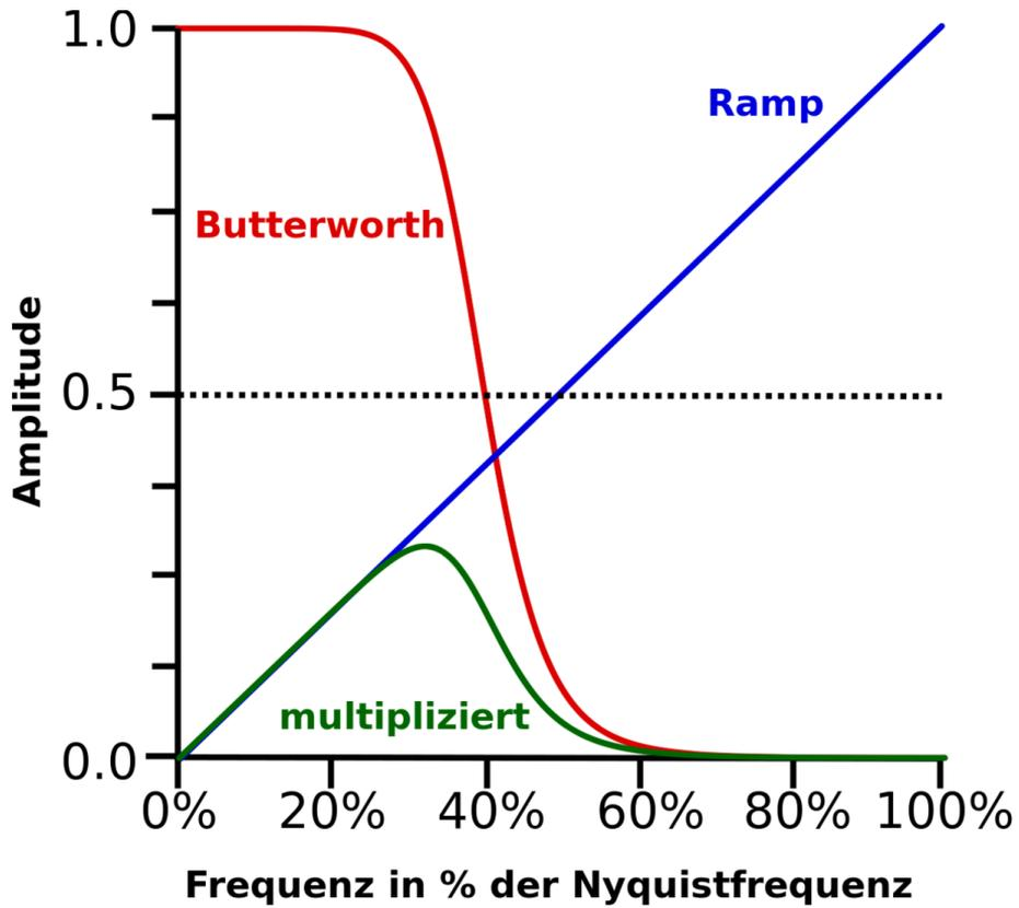
Abb. 154 Ramp- und Butterworthfilter (Fünfte Ordnung 40% Cutoff)
