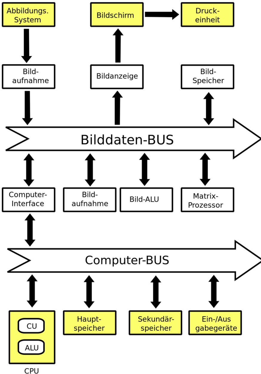
**Abb. 100** Blockdiagramm eines Computers für digitale Bildverarbeitung
