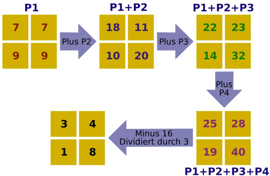
**Abb. 74** Darstellung des Rechenprozesses der gefilterten Rückprojektion.
