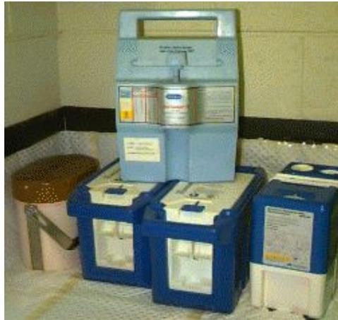
**Abb. 95** Fünf  $^{99m}\text{Tc}$  Generatoren.
