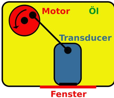
**Abb. 167** Mechanischer Transducer als Kolbenmaschine
