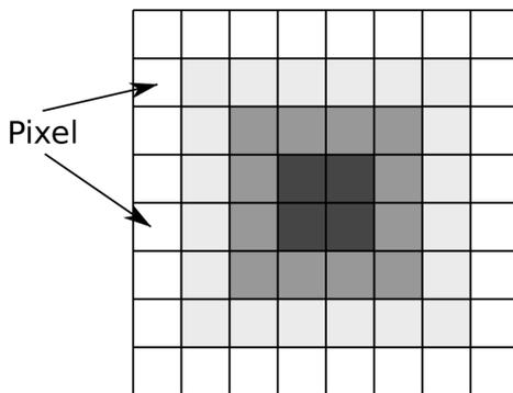
**Abb. 101** Illustration eines digitalisierten Bildes, das man erhält, wenn ein Original, bestehend aus einer dunklen Region in der Mitte und zunehmender Helligkeit gegen den Rand hin mit  $N=8$  und  $G=4$  digitalisiert wird (d.h.  $m=2$ )
