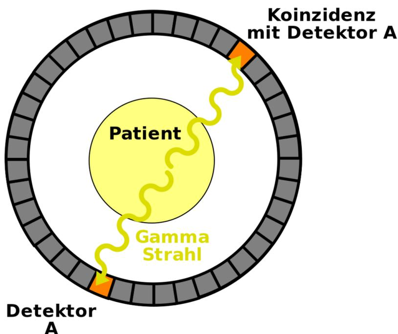
**Abb. 89** Schematische Darstellung eines Koinzidenzereignisses im Detektorring eines Positronenemissionstomographen
