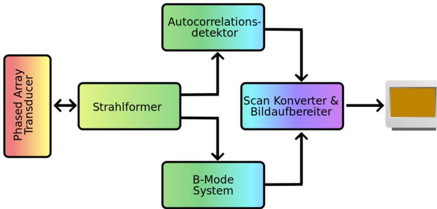
**Abb. 179** Blockdiagramm eines System zur Erstellung flussgeschwindigkeitscodierter Dopplersonogramme
