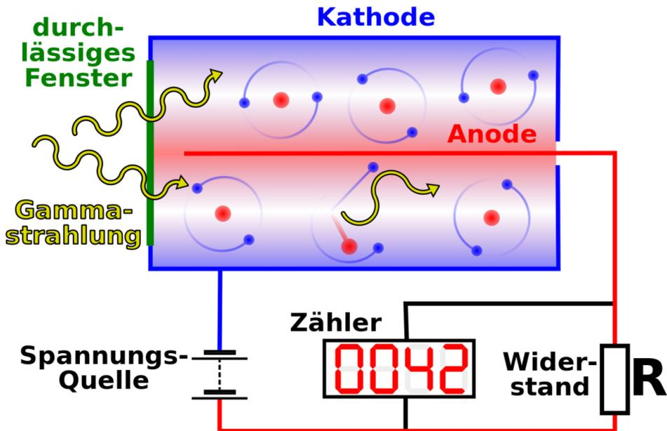
Abb. 28 Geiger Müller Zählrohr mit Beschaltung
