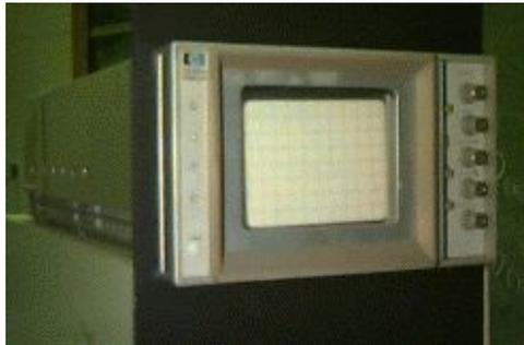
**Abb. 56** Kathodenstrahloszilloskop einer Gammakamera.
