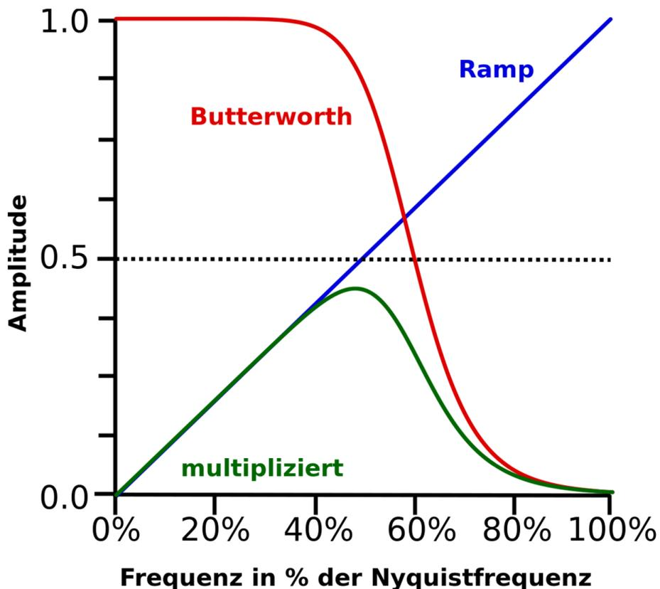
Abb. 153 Ramp- und Butterworthfilter (Fünfte Ordnung 60% Cutoff)
