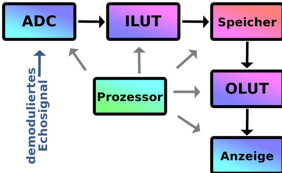
**Abb. 169** Vereinfachtes Blockdiagramm der Elektronik eines B-Mode Ultraschallgerätes.
