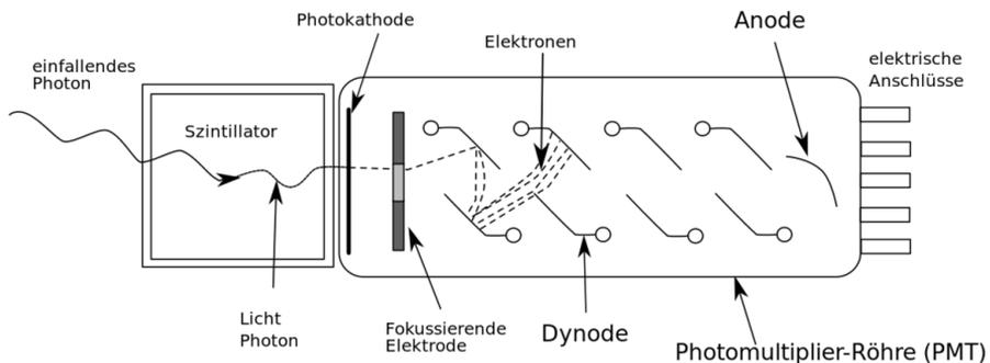
**Abb. 38** Schemazeichnung einer Photomultiplieröhre
