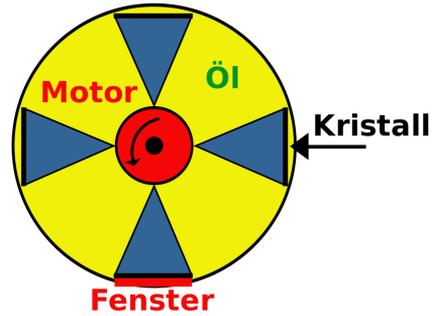
**Abb. 168** Mechanischer Transducer mit rotierenden Kristallen
