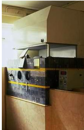
Abb. 96: Bleiabschirmung um eine Flowbox in der Radiopharmaka hergestellt werden.
