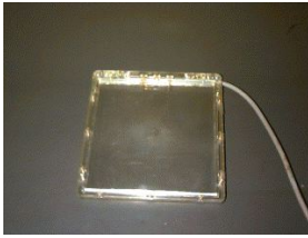
Abb. 31: Ein Flächendetektor, wie er in der Radiographie verwendet wird
