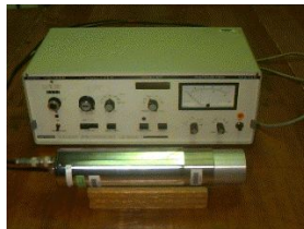
Abb. 45: Ein Einkanalanalysator mit einem Kristall-Photomultiplier-Aufbau.
