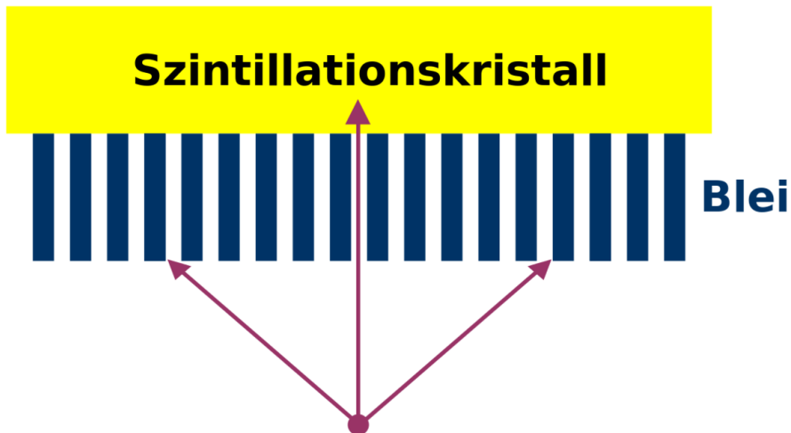
Abb. 61: Diagramm eines, mit dem Kristall einer Gammakamera verbundenen, Parallellochkollimators. Schräg einfallende Gammastrahlen werden von den Septen absorbiert.
