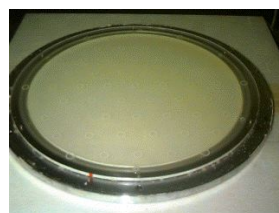
Abb. 55: Der NaI Kristall einer Gammakamera.
