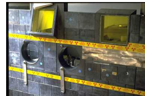
Abb. 97: Die Blei Abschirmung um die Flowbox aus einer anderen Perspektive.
