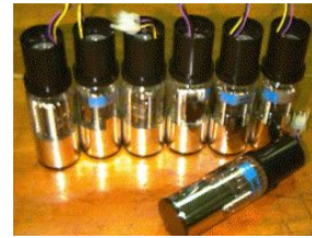
Abb. 44: Einige identische Photomultiplerröhren von einer Gammakamera.
