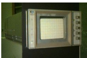
Abb. 57: Kathoden- strahloszilloskop einer Gammakamera.
