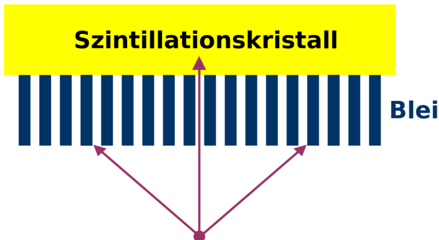
Abb. 62: Diagramm eines, mit dem Kristall einer Gammakamera verbundenen, Parallellochkollimators. Schräg einfallende Gammastrahlen werden von den Septen absorbiert.
