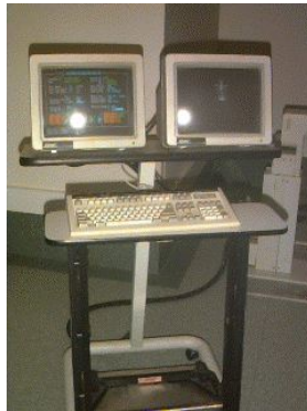
Abb. 61: Der Bildbearbeitungsarbeitsplatz einer Gammakamera mit zwei Köpfen.
