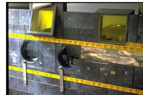
Abb. 98: Die Blei Abschirmung um die Flowbox aus einer anderen Perspektive.
