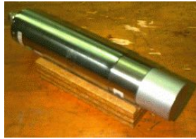
Abb. 43: Ein NaI Kristall, der mit einem Photomultiplier verbunden ist.
