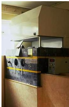
Abb. 97: Bleiabschirmung um eine Flowbox in der Radiopharmaka hergestellt werden.
