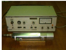
Abb. 46: Ein Einkanalanalysator mit einem Kristall-Photomultiplier-Aufbau.
