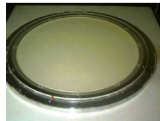
Abb. 56: Der NaI Kristall einer Gammakamera.
