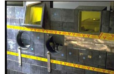
Abb. 98: Die Blei Abschirmung um die Flowbox aus einer anderen Perspektive.
