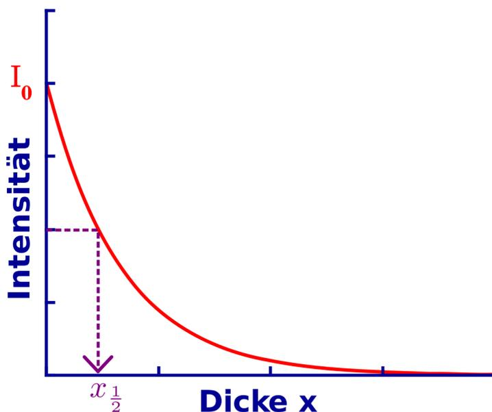
Abbildung 27: Exponentielle Dämpfung von Strahlung (die Halbwertszeit ist kenntlich gemacht)
