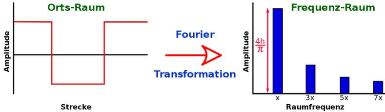
Abbildung 148: Die Fourier-Transformation kann verwendet werden um das Fourier-Spektrum jeder beliebigen Wellenform zu berechnen, wie hier am Beispiel der Rechteckfunktion gezeigt wird.
