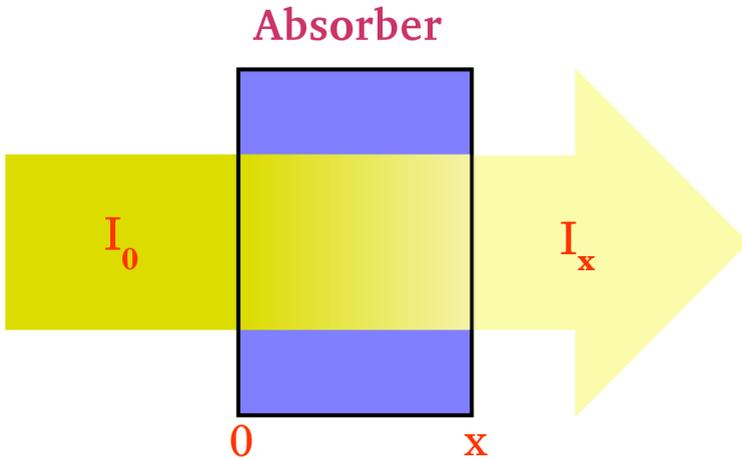
Abbildung 21: Teilweise Absorption von Strahlung beim Durchgang durch einen Absorber
