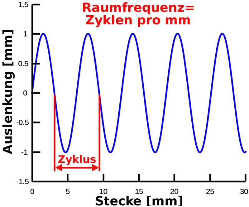
Abbildung 133: räumlicher Verlauf einer Sinuswelle
