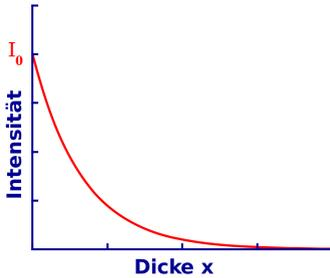
Abbildung 24: Exponentielle Dämpfung von Strahlung
