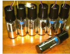
Abbildung 44: Einige identische Photomultiplier-Röhren von einer Gammakamera.
