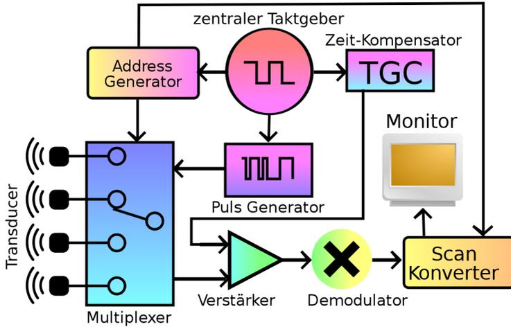
Abbildung 164: Vereinfachtes Blockdiagramm eines Ultraschallscanners, mit linearer Transducer Anordnung
