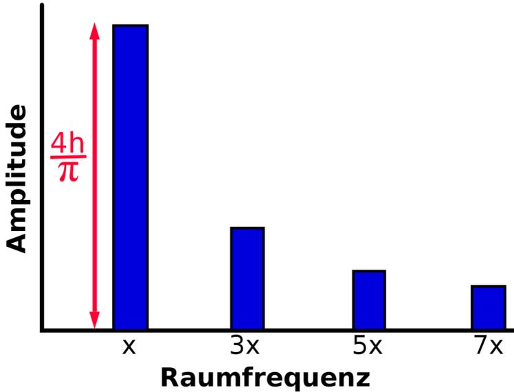
Abbildung 147: Fourierspektrum einer Rechteckwelle.
