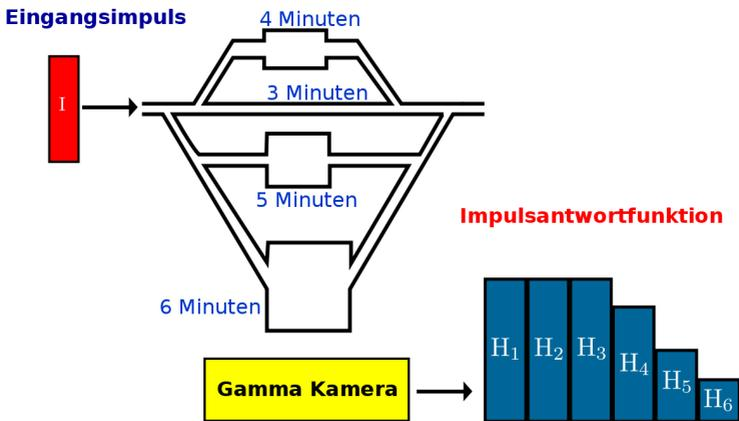
Abbildung 157: Darstellung eine Gammakamera die auf eine hypothetische Niere gerichtet ist.
