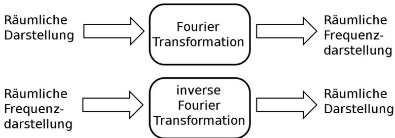
Abbildung 125: Illustration der Verwendung der Fourier-Transformation. Die FT und ihre Umkehrung erlaubt uns Bilddaten aus der Ortsdarstellung in die Raumfrequenzdarstellung und wieder zurück zu transformieren.
