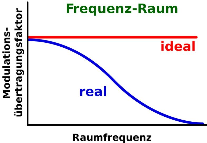
Abbildung 152: Darstellung der MTF eines idealen und eines realen Abbildenden Systems.
