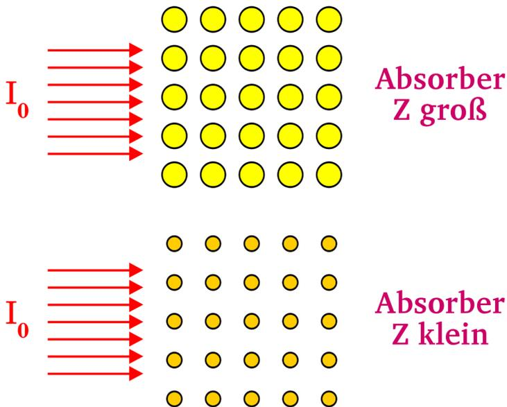
Abbildung 22: Abhängigkeit der Absorption von Gammastrahlung von der Kernladungszahl
