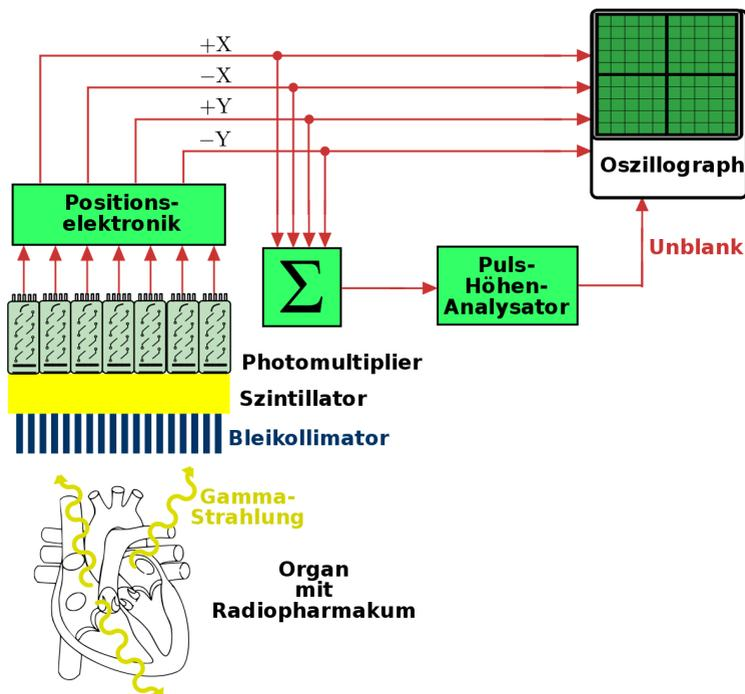
Abbildung 53: Blockdiagramm einer Gammakamera
