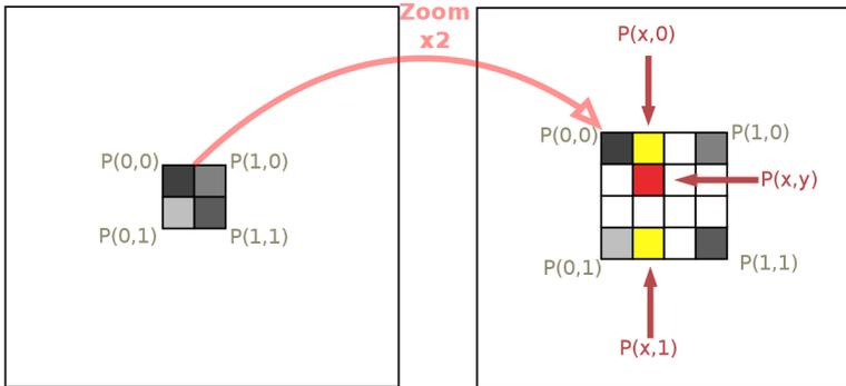
Abbildung 123: Darstellung des Interpolationsverfahren zur Vergrößerung eines Bildes um den Faktor zwei.
