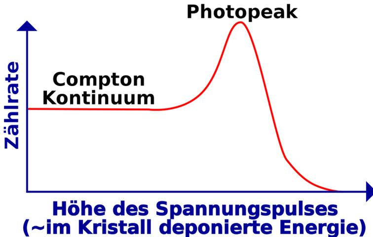
Abbildung 48: Gammaspektrum eines monoenergetischen Strahlers
