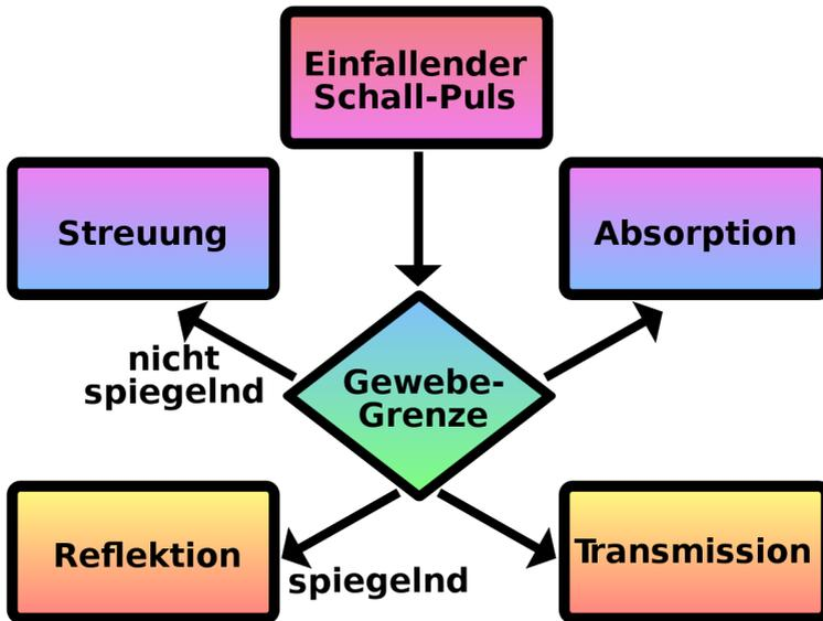
Abbildung 163: Blockdiagramm einiger Wechselwirkungen akustischer Wellen mit einer Grenzfläche zweier Gewebe
