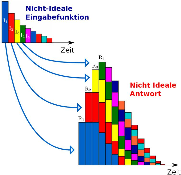
Abbildung 158: Darstellung einer Antwortfunktion bei einer nicht idealen Eingangsfunktion
