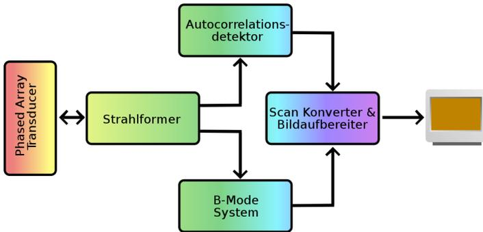
Abbildung 180: Blockdiagramm eines System zur Erstellung Flussgeschwindigkeitscodierter Dopplersonogramme
