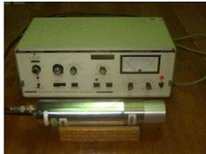
Abbildung 46: Ein Einkanalanalysator mit einem Kristall-Photomultiplier-Aufbau.
