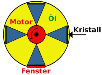
Abbildung 169: Mechanischer Transducer mit rotierenden Kristallen
