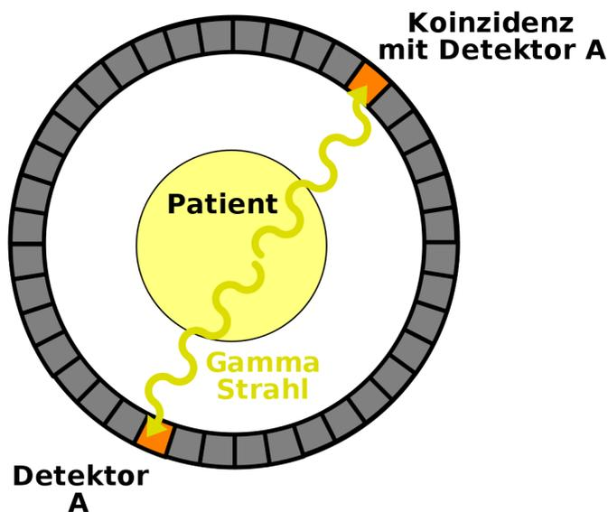
Abbildung 90: Schematische Darstellung eines Koinzidenzereignisses im Detektorring eines Positronenemissionstomographen
