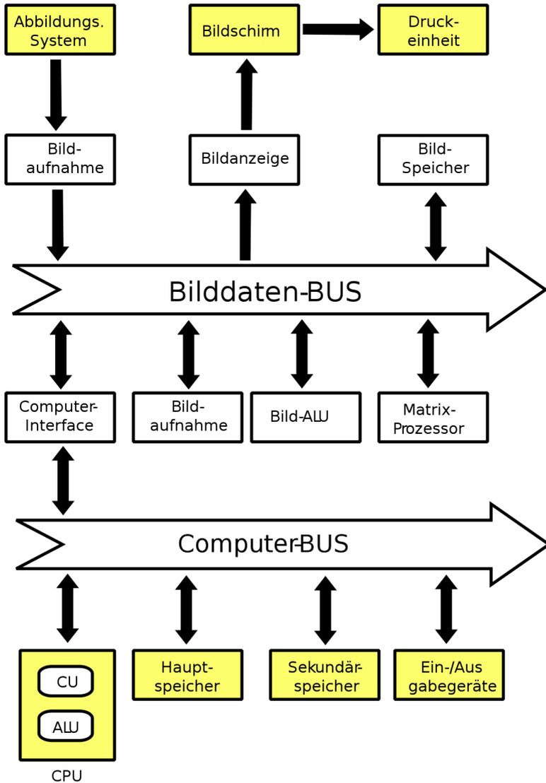
Abbildung 101: Blockdiagramm eines Computers für digitale Bildverarbeitung
