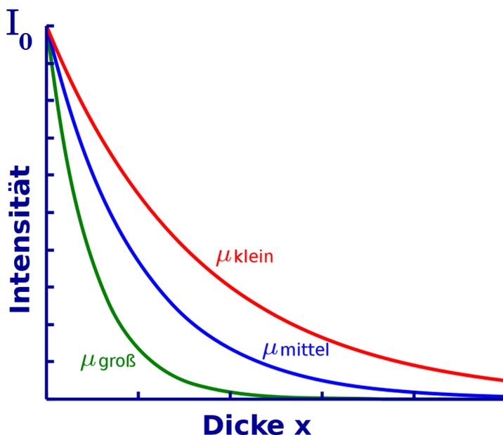
Abbildung 26: Exponentielle Dämpfung von Strahlung in Abhängigkeit des linearen Schwächungskoeffizienten
