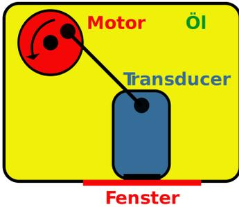
Abbildung 168: Mechanischer Transducer als Kolbenmaschine
