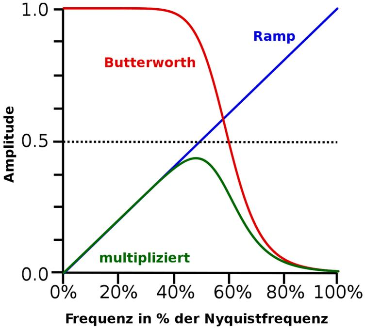
Abbildung 154: Ramp- und Butterworthfilter (Fünfte Ordnung 60% Cutoff)
