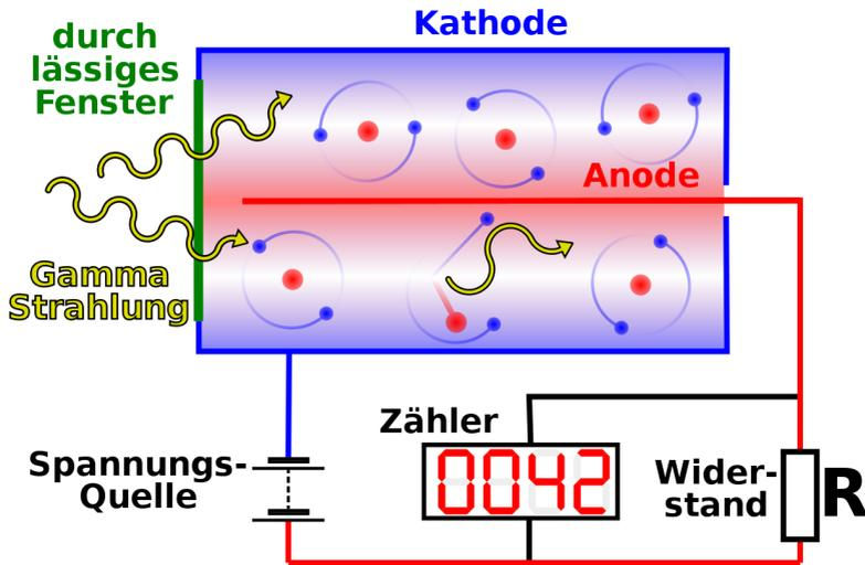
Abbildung 29: Geiger Müller Zählrohr mit Beschaltung
