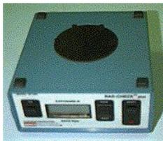
Abbildung 36: Ein Dosimeter wie es in der Radiographie verwendet wird.
