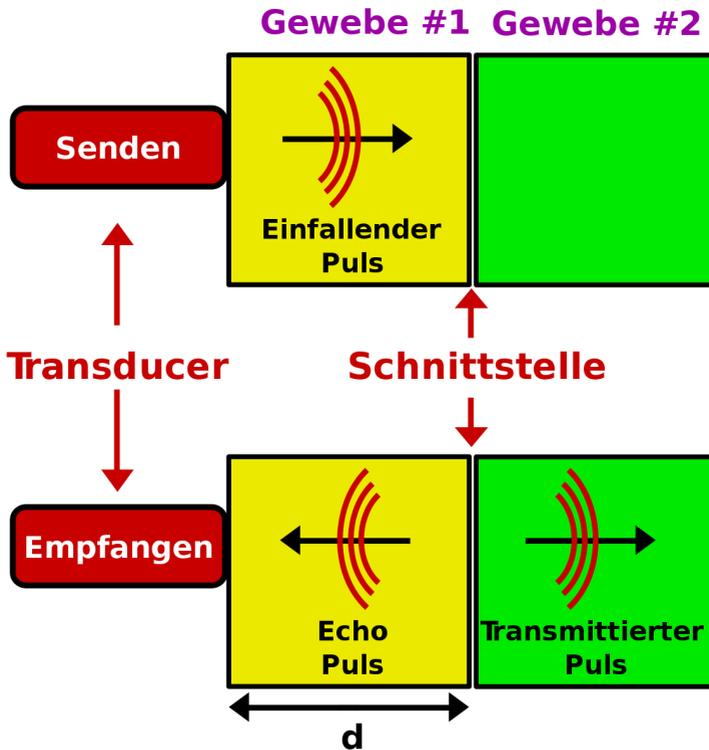
Abbildung 162: Darstellung des Puls Echo Prinzips bei der Ultraschall-Bildgebung
