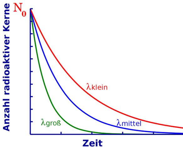
Abbildung 10: Exponentieller Zerfall von Kernen in Abhängigkeit von der Zerfallskonstante
