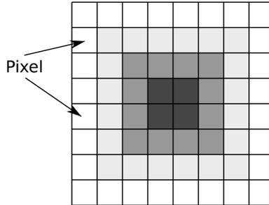
Abbildung 102: Illustration eines digitalisierten Bildes, das man erhält, wenn ein Original, bestehend aus einer dunklen Region in der Mitte und zunehmender Helligkeit gegen den Rand hin mit  $N=8$  und  $G=4$  digitalisiert wird (d.h.  $m=2$ )
