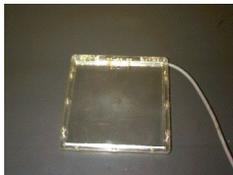
Abbildung 32: Ein Flächendetektor, wie er in der Radiographie verwendet wird
