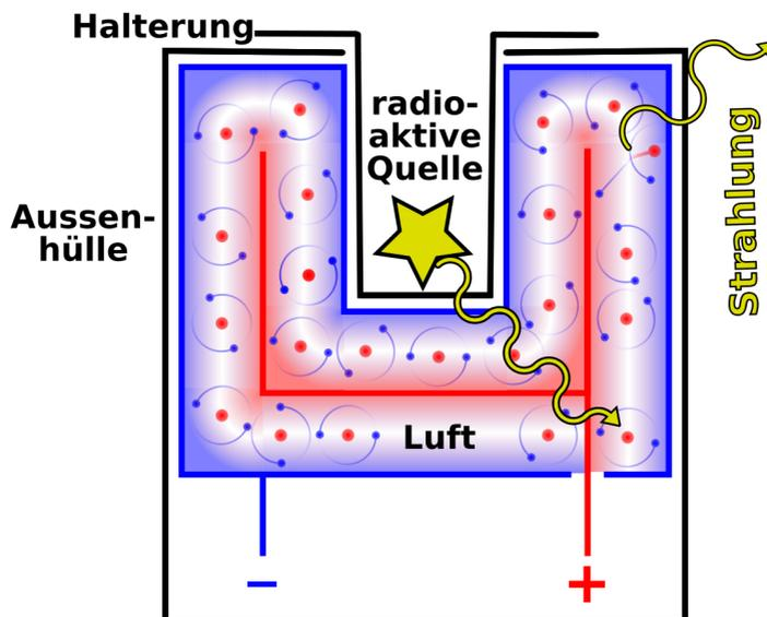
Abbildung 31: Dosiskalibrator (schematisch)
