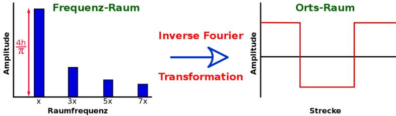
Abbildung 149: Die inverse Fourier-Transformation kann verwendet werden um beliebige periodische Wellenformen beliebig genau anzunähern, wie hier am Beispiel der Rechteckfunktion gezeigt wird.
