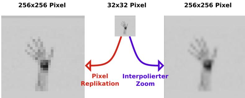
Abbildung 124: Vergleich des Interpolations- sowie des Pixelreplikations- Verfahrens zur Vergrößerung eines Bildes
