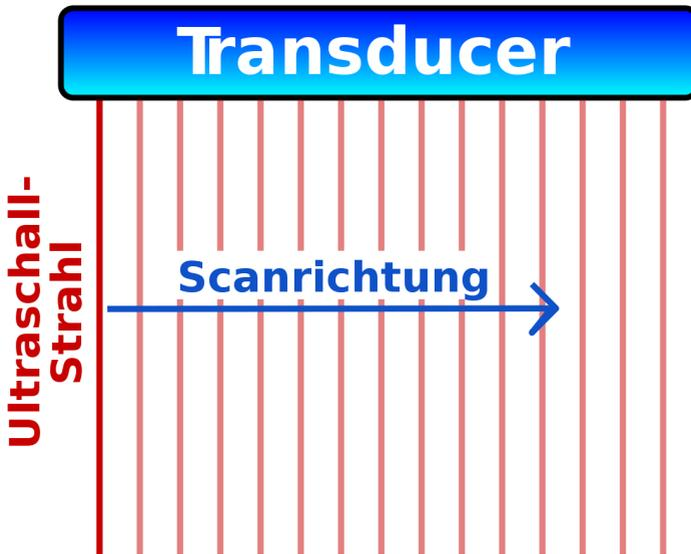
Abbildung 165: Vereinfachtes Blockdiagramm eines Ultraschallscanners, mit linearer Transducer Anordnung
