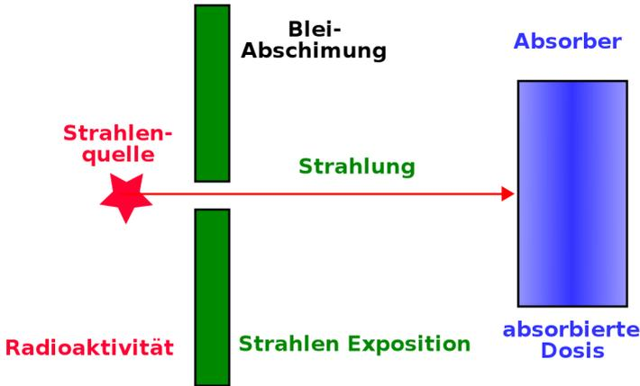
Abbildung 15: Experimenteller Aufbau zur Messung der Absorption von Strahlung
