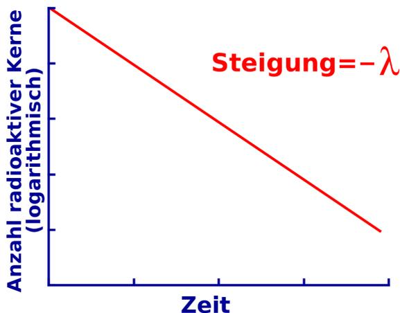
Abbildung 11: Exponentieller Zerfall von Kernen (logarithmische Darstellung)
