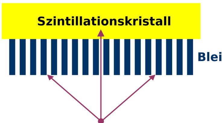
Abbildung 62: Diagramm eines, mit dem Kristall einer Gammakamera verbundenen, Parallellochkollimators. Schräg einfallende Gammastrahlen werden von den Septen absorbiert.
