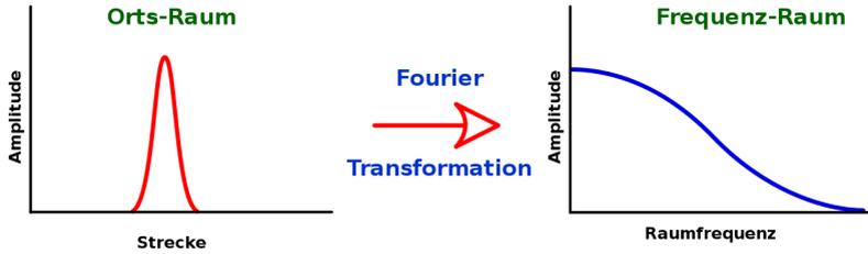
Abbildung 151: Die Fourier Transformierte einer verbreiterten Delta Funktion.
