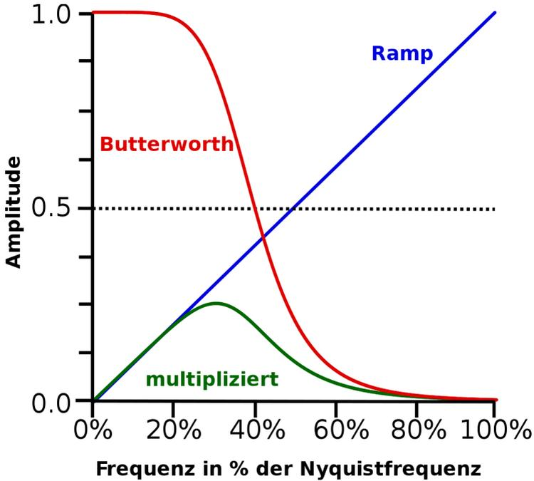
Abbildung 156: Ramp- und Butterworthfilter (Dritte Ordnung 40% Cutoff)
