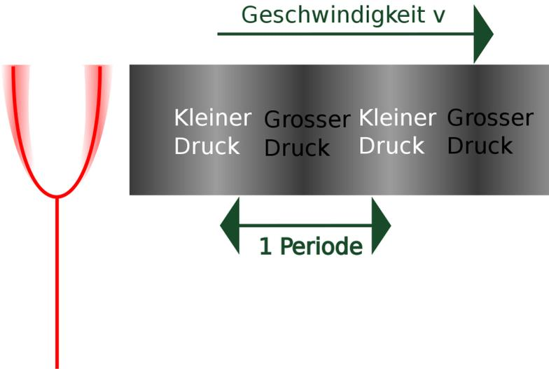
Abbildung 161: Darstellung einer schwingenden Stimmgabel, die eine Reihe von Regionen hoher und niedriger Dichte in der umgebenden Luft hervorruft.
