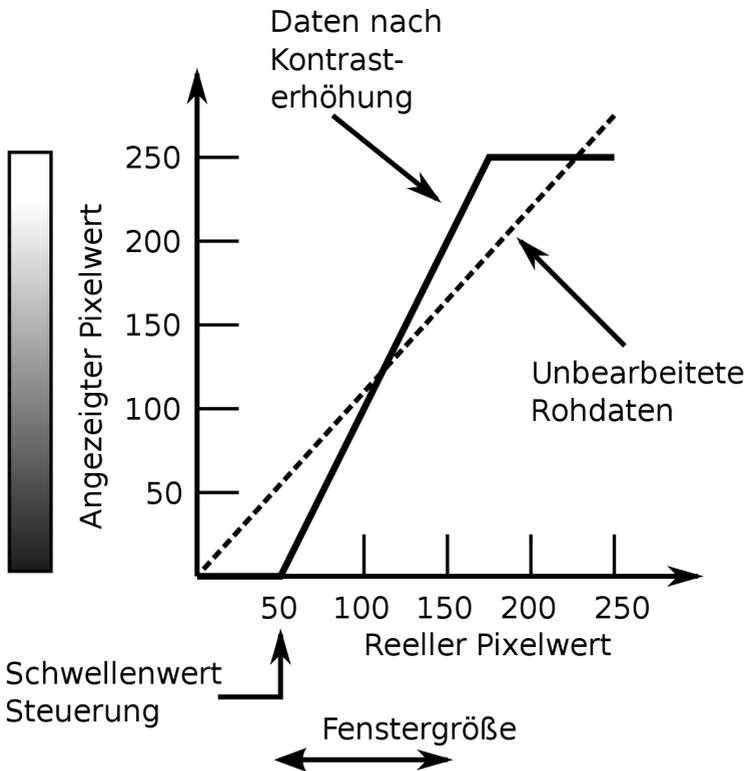
Abbildung 106: Illustration einer Graustufen-Transformation, welche für Kontraststeigerung in Bildern mit 256 Graustufen (d.h.  $m=8$ ) benutzt wird. In diesem Beispiel werden die unverarbeiteten Rohdaten so transformiert, dass alle Pixel mit einem Pixelwert von weniger als 50 schwarz, alle Pixel mit Pixelwert größer als 150 als weiß und alle Pixel mit Werten zwischen 50 und 150 mit einem Grauton dazwischen dargestellt werden.
