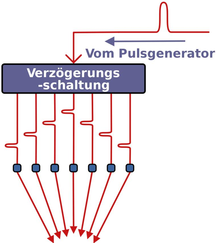
Abbildung 167: Ultrasektorscanner / Phased Array Technik
