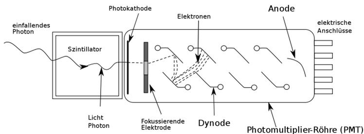
Abbildung 39: Schemazeichnung einer Photomultiplier-Röhre
