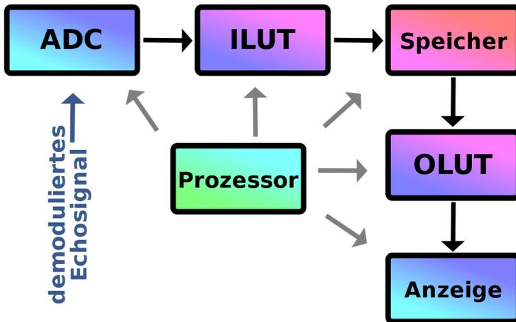
Abbildung 170: Vereinfachtes Blockdiagramm der Elektronik eines B-Mode Ultraschallgerätes.
