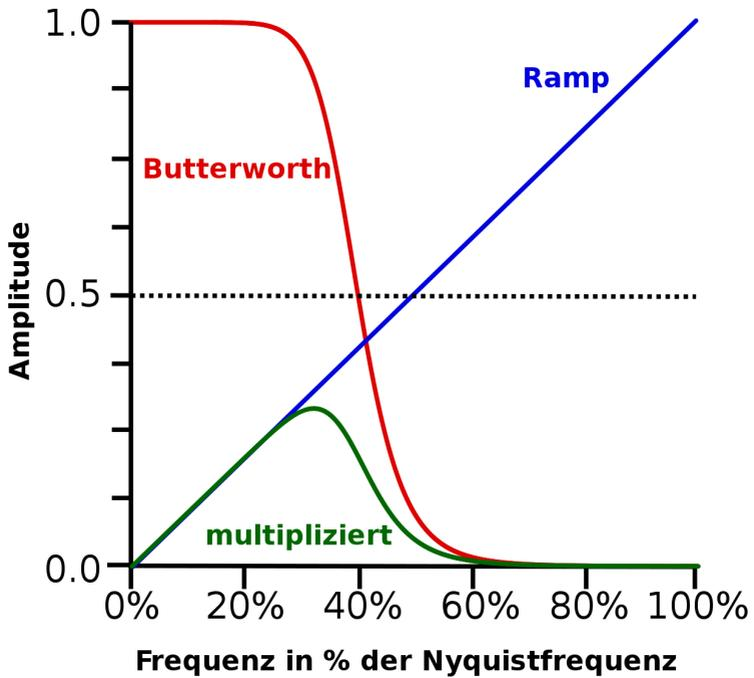
Abbildung 155: Ramp- und Butterworthfilter (Fünfte Ordnung 40% Cutoff)
