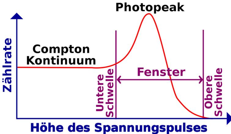
Abbildung 50: Gammapektrum mit eingezeichneten Diskriminatorschwellen
