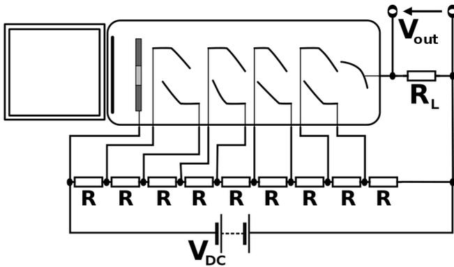
Abbildung 40: Schemazeichnung einer Photomultiplerröhre mit Beschaltung
