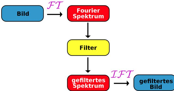
Abbildung 153: Die Filterung des Fourierspektrums
