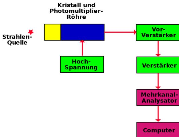
Abbildung 52: Komplexes Szintillationsspektrometer
