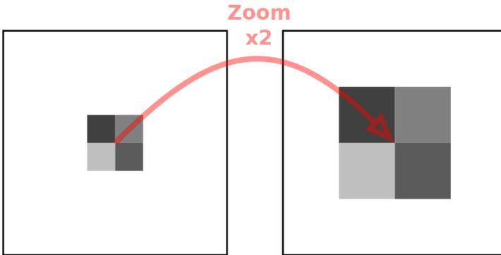
Abbildung 122: Darstellung des Pixelreplikationsverfahrens um ein Bild um den Faktor 2 zu vergrößern.
