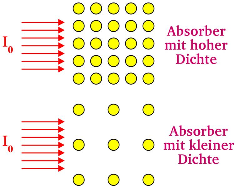
Abbildung 23: Abhängigkeit der Absorption von Gammastrahlung von der Teilchendichte
